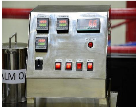
รูปที่ 3. 9 เครื่องควบคุมอุณหภูมิ (temperature controller) แต่ละส่วนของคอลัมน์
