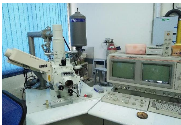
รูปที่ 3. 3 กล้องจุลทรรศน์อิเล็กตรอนแบบส่องกราด ยี่ห้อ JEOL รุ่น JSM-6400
