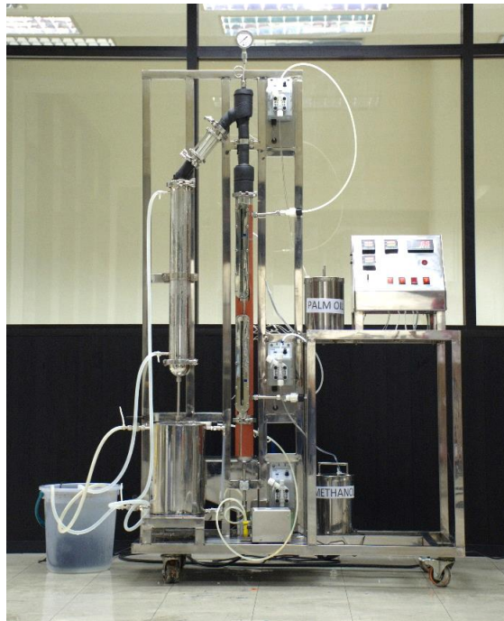
รูปที่ 3. 7 เครื่องปฏิกรณ์แบบเบตนิ่งระดับต้นแบบ (pilot-scale) สำหรับการผลิตอย่างต่อเนื่องของ ไบโอดีเซลความบริสุทธิ์สูง
