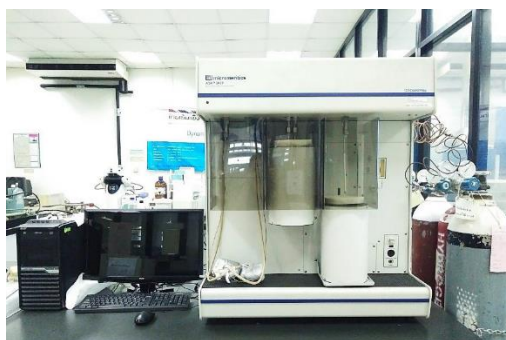
รูปที่ 3. 4 เครื่องวิเคราะห์พื้นที่ผิวและรูพรุน ยี่ห้อ Micromeritics รุ่น ASAP 2020
