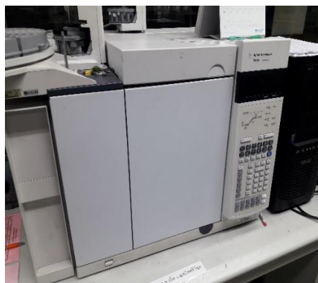
รูปที่ 3. 5 เครื่องแก๊สโครมาโทกราฟียี่ห้อ Agilent รุ่น 7890A สำหรับการวิเคราะห์หา FAME yield
