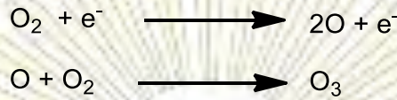
รูปที่ 1.6 ปฏิกิริยาการเกิดโอโซนด้วยวิธี corona discharge
