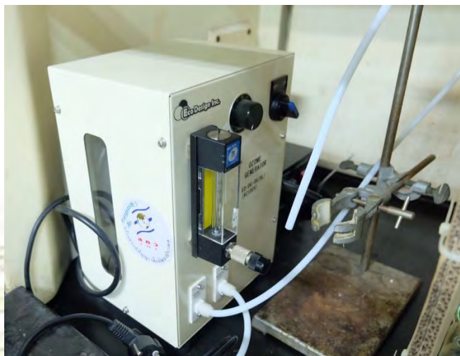
รูปที่ 2.3 เครื่องผลิตโอโซนที่ใช้ในงานวิจัย
