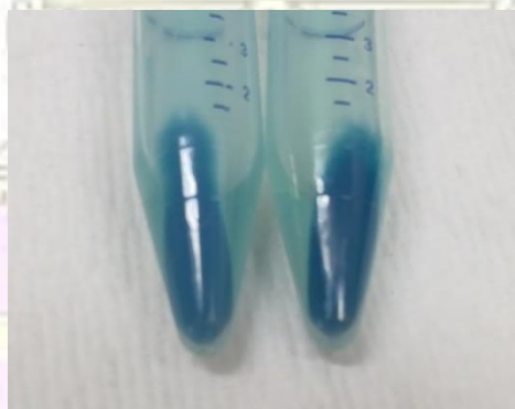
รูปที่ 3.3 แสดงสีของแอนโทไซยานินที่ติดบนแคลเซียมคาร์บอเนตโดยใช้ความเข้มข้นต่ำ
