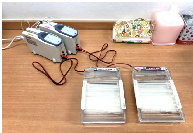
ภาพที่ 13 ชุดอุปกรณ์สำหรับทำ agarose gel electrophoresis ประกอบด้วย power supply, electrophoresis tank และ gel casting system
