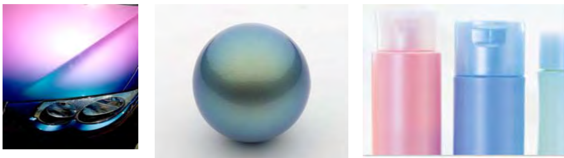
รูปที่ 2.1 ตัวอย่างการนำ interference pigment มาใช้งาน
