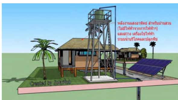
ภาพที่ 2.1 ระบบออฟกริด (Off Grid) หรือแบบอิสระ (Stand Alone)
