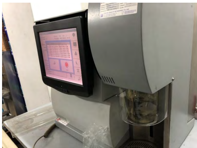
รูปที่ 3.2 เครื่องวิเคราะห์สภาพเส้นเยื่อ (Fiber Quality Analyzer), model LDA02 Optest
