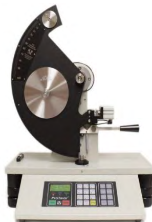
รูปที่ 3.6 เครื่องวัดค่าความต้านทานแรงฉีก (Thwing-Albert Protear)
