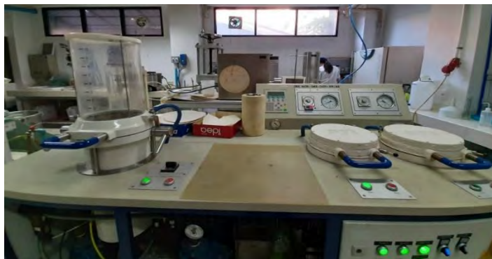
รูปที่ 3.3 เครื่องทำแผ่นแบบรวดเร็ว (Rapid Köthen Sheet Machine), PTI
