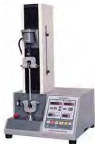
รูปที่ 3.5 เครื่องทดสอบแรงดึง (Strograph Model E-S), Toyoseiki แหล่งที่มา: http://xebex.jp/_userdata/Toyo-210-E.pdf
