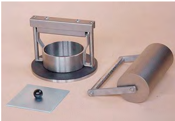
รูปที่ 3.4 เครื่องมือทดสอบการดูดซึมน้ำของกระดาษ (Cobb tester), Regmed แหล่งที่มา: https://www.chemihouse.com/images/REGMEDPAPER/image004.gif
