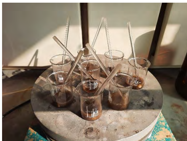
รูปที่ 2.3 ก.) เม็ดไลโคโปเดียม (Lycopodium Tablets) ข.) การทำละลายตะกอนและไลโคโปเดียมด้วยโพแทสเซียมไฮดรอกไซด์บนเครื่องให้ความร้อน
