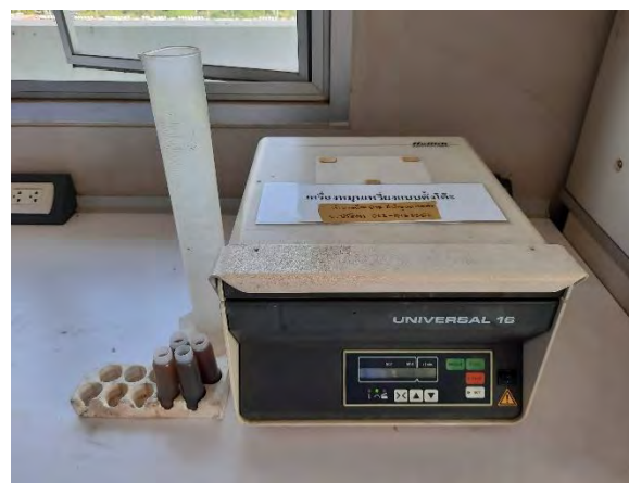
รูปที่ 2.4 ก.) กรองตะกอนบนกระดาษกรอง 200 ไมครอน ข.) ปั่นแยกตะกอนโดยใช้เครื่องปั่นแยกความถี่ 2,000 รอบต่อนาที
