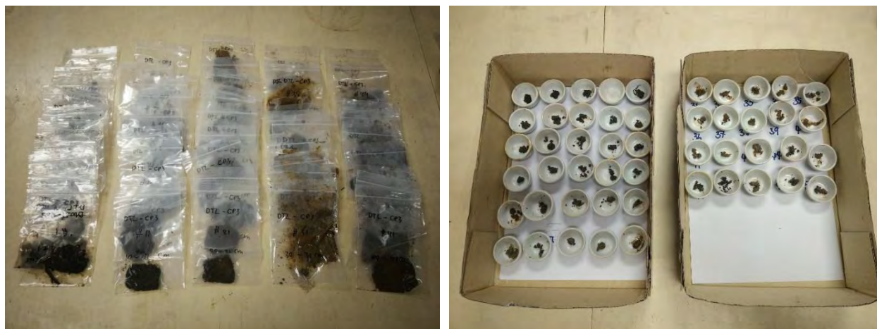
รูปที่ 2.1 ก.) แบ่งตะกอนขนาด 1 ลูกบาศก์เซนติเมตร จำนวน 100 ตัวอย่าง ข.) ตัวอย่างตะกอนในเบ้าทนไฟ (Crucible) โดยเตาเผาสามารถบรรจุเบ้าทนไฟครั้งละ 50 ถ้วย
