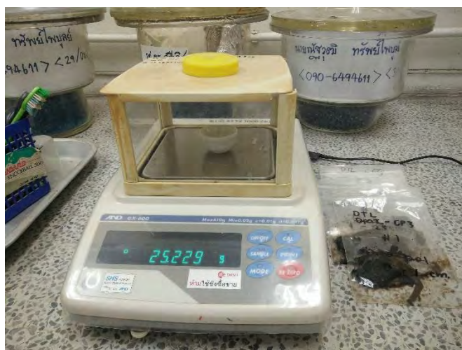
รูปที่ 2.2 ก.) ชั่งน้ำหนักตะกอนและเบ้าทนไฟ ก่อนและหลังการทำให้อุณหภูมิ 550 และ 950 องศาเซลเซียส ข.) เตาเผาอุณหภูมิสูง
