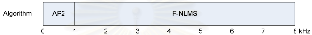
รูปที่ 4.20 การแบ่งแถบความถี่ย่อยสำหรับการประมวลผลด้วยโครงสร้างไฮบริดที่นำเสนอแบบที่หนึ่ง
