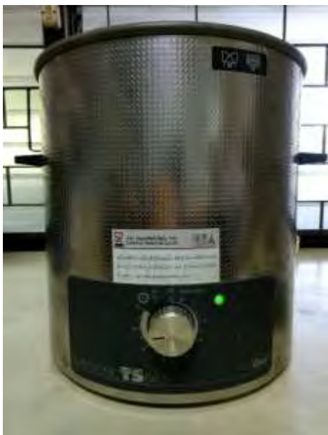
รูปที่ 2.8 เครื่องล้างความถี่สูง (Ultrasonic cleaning machine) รูปที่ 2.9 เครื่องหมุนเหวี่ยง (Centrifuge)
