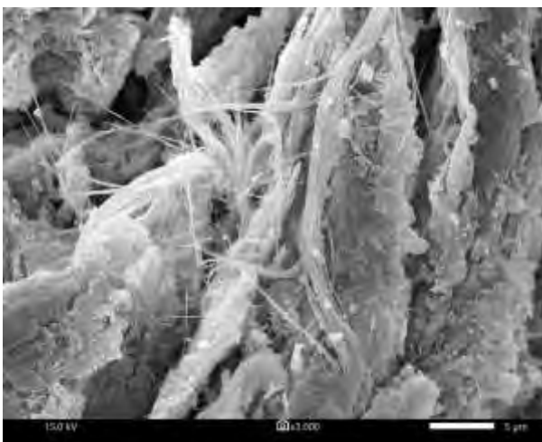
g) ลักษณะ Asbestiform ของแร่ใยหินโครโซไทล์ ตัวอย่าง MAT กำลังขยาย 3,000 เท่า
