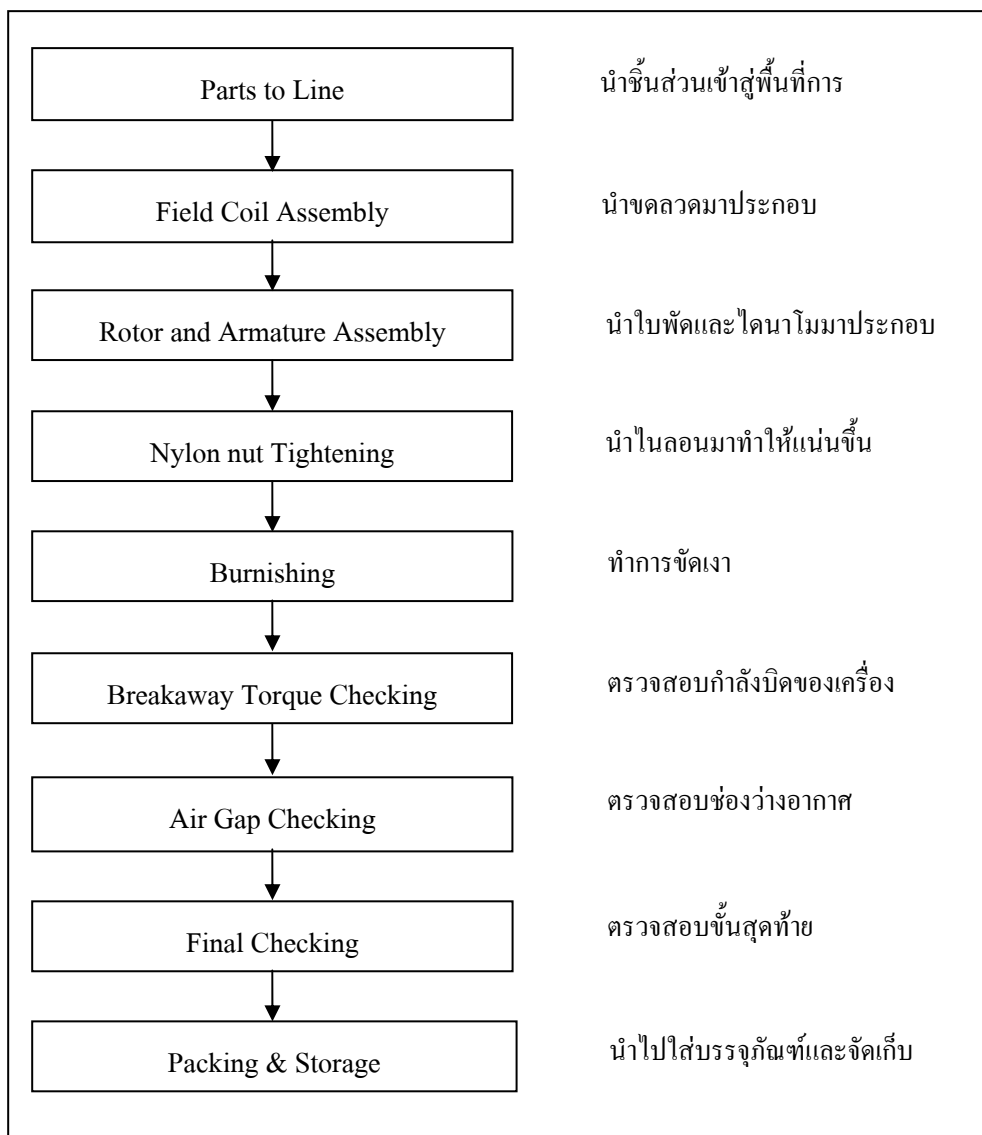
รูปที่ 3.20 แสดงกระบวนการผลิต Compressor
