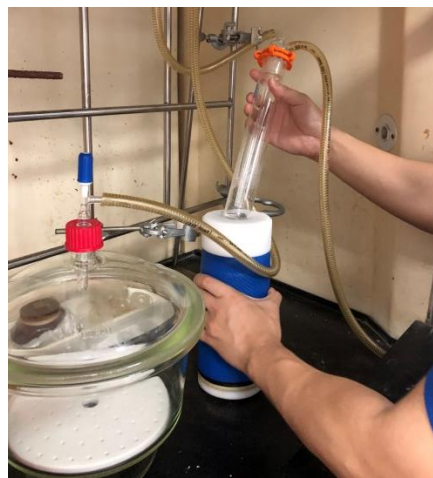
รูปที่ 6.11 นำสารสกัด ทำ high vacuum เพื่อให้สารแข็งตัว
