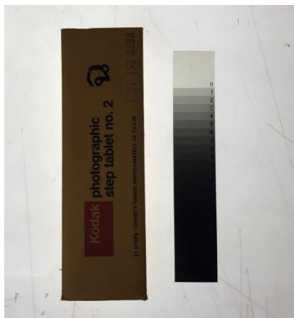
ภาพที่ 11 Kodak photographic step tablet no.2 21 steps (step wedge)
