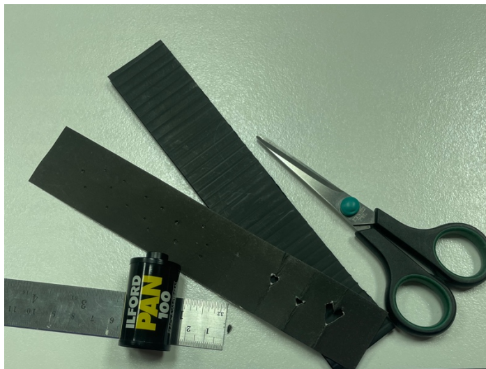
ภาพที่ 3-2 เตรียมการฉายแสงผ่านช่องเปิดขนาดเล็กโดยใช้กระดาษแข็งเจาะรูเป็นรูป
