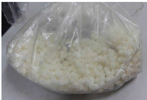
รูปที่ 10 Aquaporous gel ขนาด 0.8 x 0.8 x 0.8 เซนติเมตร ( Length x Width x Height )
