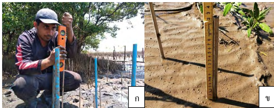
ภาพที่ 3.6 ศึกษาการเปลี่ยนแปลงระดับความสูงสัมพัทธ์ของพื้นที่ (relative elevation change) (ก) ติดตั้ง stainless steel pins (ข) วัดความสูงของ stainless steel pins
