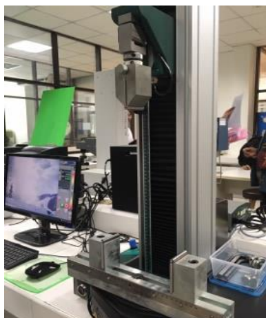
รูปที่ 3.4 เครื่องทดสอบอเนกประสงค์ที่ติดตั้งชุดทดสอบแรงกระทำ 3 จุด
