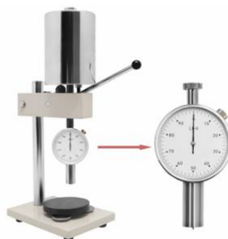
รูปที่ 3.2 เครื่องทดสอบความแข็ง (ที่มา : Amazon.com, 2017)
