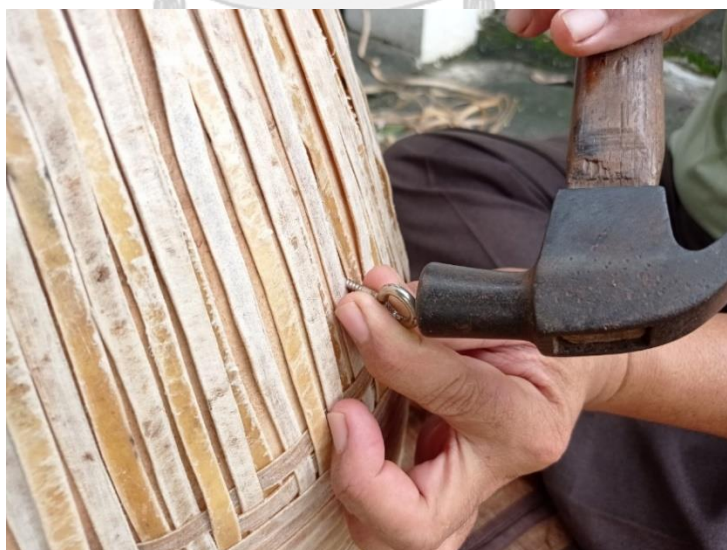
ภาพที่ 159 การตอกตะขอตาไก่ลงบนหุ่นตะโพน (ที่มา: ผู้วิจัย บันทึกภาพเมื่อวันที่ 23 สิงหาคม พ.ศ. 2564)
