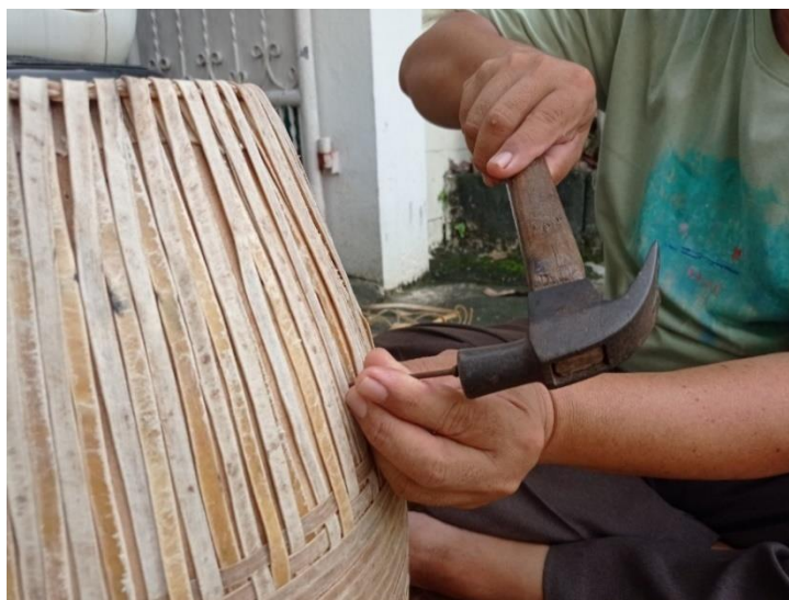
ภาพที่ 158 การเจาะรูที่หุ่นตะโพนด้วยค้อนและตะปูสามนิ้ว (ที่มา: ผู้วิจัย บันทึกภาพเมื่อวันที่ 23 สิงหาคม พ.ศ. 2564)
