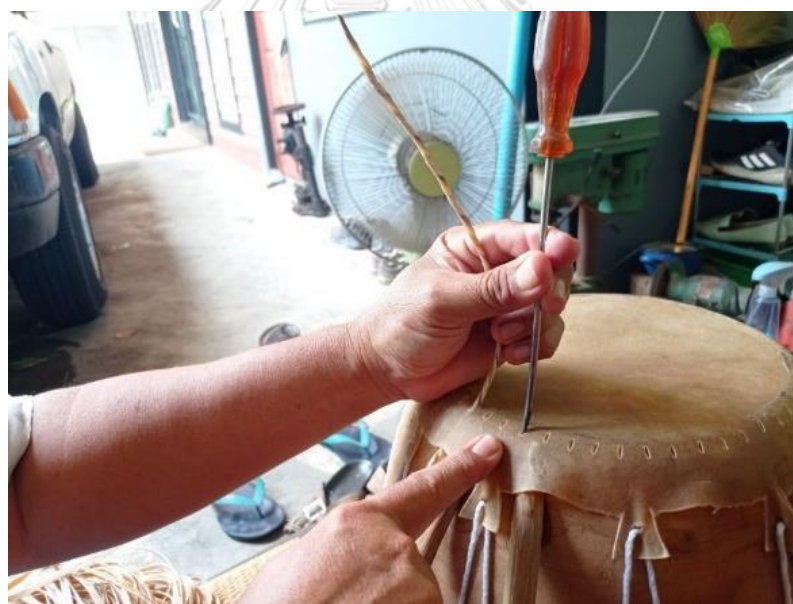
ภาพที่ 169 ลักษณะเฉพาะของการถักไส้ละมานในขณะที่หน้ากลองหน้าอยู่บนตัวกลอง (ที่มา: ผู้วิจัย บันทึกภาพเมื่อวันที่ 12 สิงหาคม พ.ศ. 2564)
