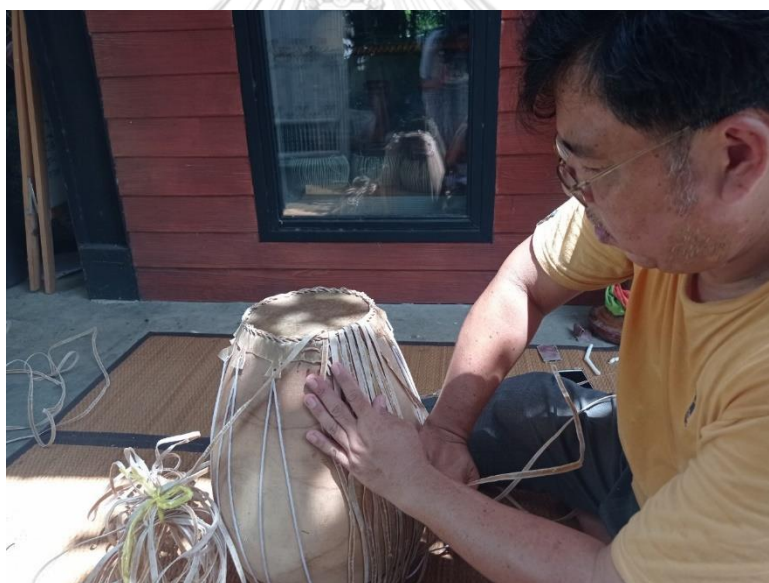
ภาพที่ 141 การร้อยหนังเรียดครั้งแรก ในทิศทางทวนเข็มนาฬิกา (ที่มา: ผู้วิจัย บันทึกภาพเมื่อวันที่ 12 สิงหาคม พ.ศ. 2564)
