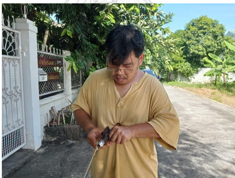
ภาพที่ 83 การควั่นไส้ละมานด้วยสว่านมือ (ที่มา: ผู้วิจัย บันทึกภาพเมื่อวันที่ 9 สิงหาคม พ.ศ. 2564)
