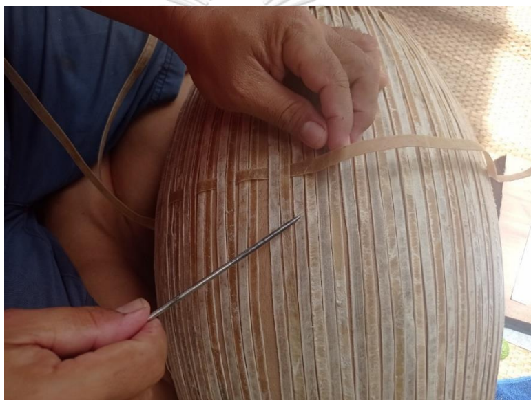
ภาพที่ 151 การสานรัดอกขึ้นและลงสลับกับหนังเรียดที่ละ 2 เส้น
