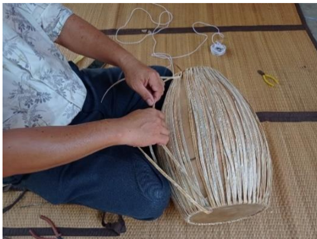
ภาพที่ 171 ลักษณะเฉพาะของการสาวตะโพนด้วยการใช้หัวเข้าเป็นอวัยวะค้ำยันหุ่นกลอง (ที่มา: ผู้วิจัย บันทึกภาพเมื่อวันที่ 21 สิงหาคม พ.ศ. 2564)
