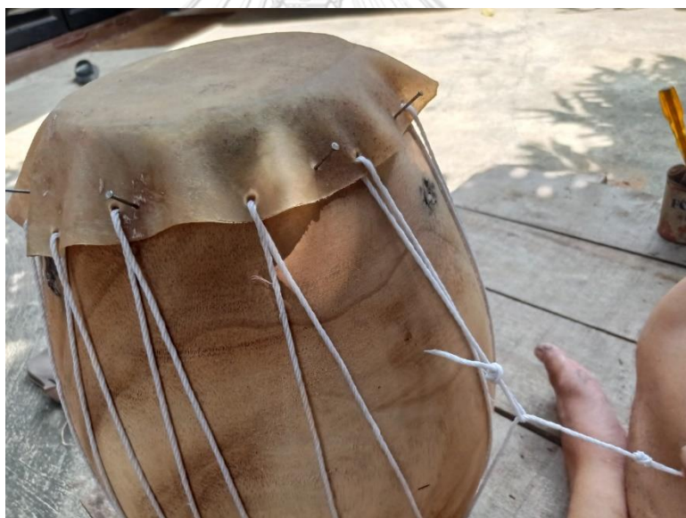
ภาพที่ 123 การผูกเชือกหลังหน่าวหนังเข้ากับหุ่นตะโพนแล้ว (ที่มา: ผู้วิจัย บันทึกภาพเมื่อวันที่ 7 สิงหาคม พ.ศ. 2564)
