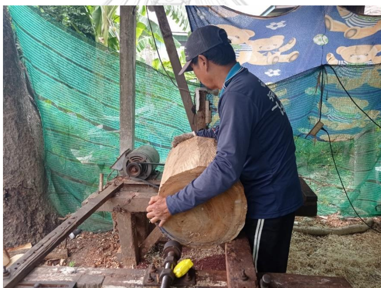
ภาพที่ 55 การนำไม้ขึ้นแท่นกลึง (ที่มา: ผู้วิจัย บันทึกภาพเมื่อวันที่ 6 สิงหาคม พ.ศ. 2564)
