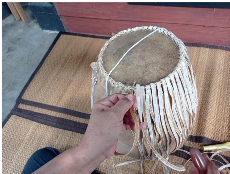
ภาพที่ 142 การร้อยหนังเรียดครึ่งหลัง ในทิศทางตามเข็มนาฬิกา (ที่มา: ผู้วิจัย บันทึกภาพเมื่อวันที่ 12 สิงหาคม พ.ศ. 2564)
