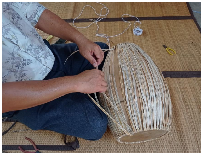
ภาพที่ 144 การสาวกลองโดยใช้หัวเข่าค้ำยัน (ที่มา: ผู้วิจัย บันทึกภาพเมื่อวันที่ 21 สิงหาคม พ.ศ. 2564)
