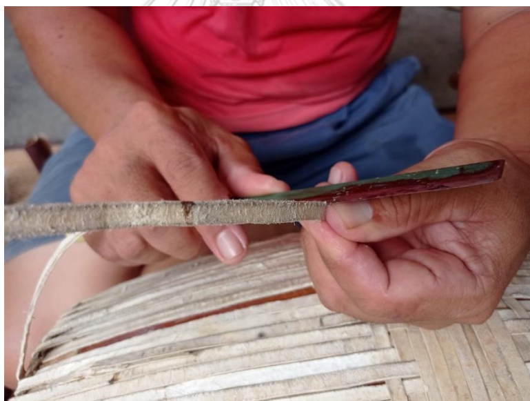
ภาพที่ 147 การบากหนังเรียดฝั่งหนึ่งให้เป็นทรงหัวลูกศร (ที่มา: ผู้วิจัย บันทึกภาพเมื่อวันที่ 22 สิงหาคม พ.ศ. 2564)
