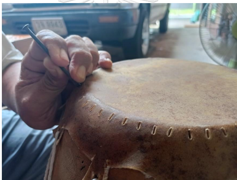
ภาพที่ 127 การตอกตะปูตีช่องไส้ละมาน
