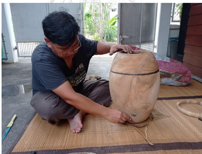
ภาพที่ 108 การวาดเส้นเพื่อกำหนดขนาดของหน้าตะโพน (ที่มา: ผู้วิจัย บันทึกภาพเมื่อวันที่ 8 สิงหาคม พ.ศ. 2564)
