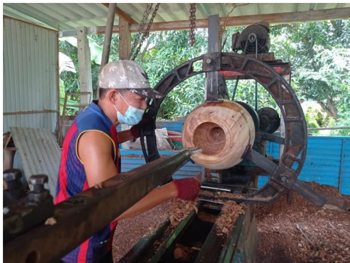
ภาพที่ 70 การคว้านหุ่นตะโพนเพื่อขยายโพรงด้านในให้กว้างขึ้น (ที่มา: ผู้วิจัย บันทึกภาพเมื่อวันที่ 6 สิงหาคม พ.ศ. 2564)
