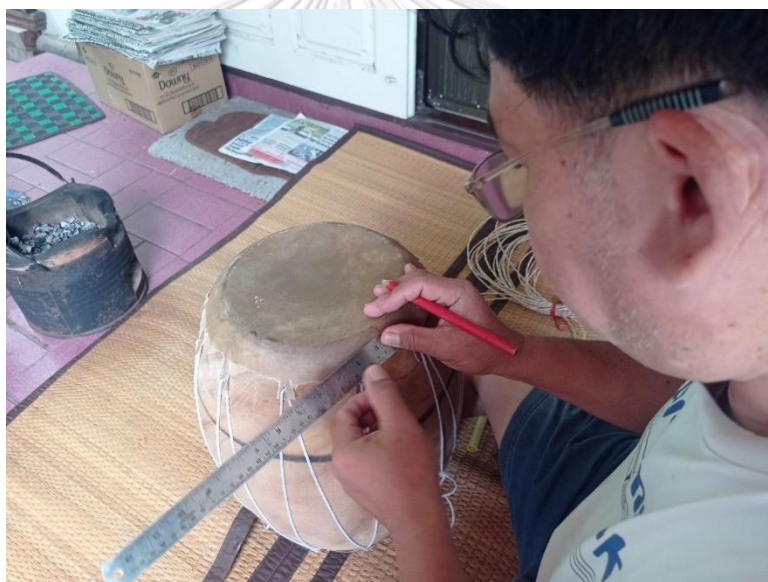
ภาพที่ 126 การขีดเส้นเพื่อกำหนดตำแหน่งของช่องไส้ละมาน (ที่มา: ผู้วิจัย บันทึกภาพเมื่อวันที่ 12 สิงหาคม พ.ศ. 2564)
