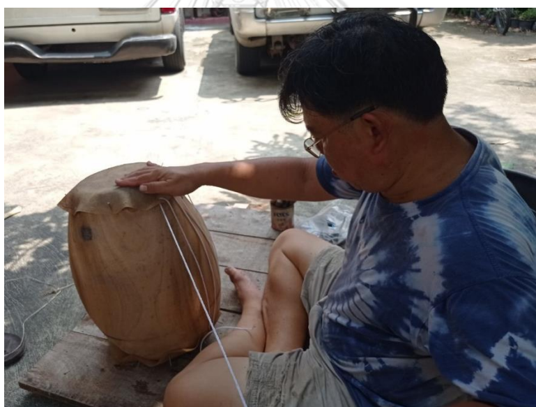
ภาพที่ 121 การร้อยเชือกหน้าหนัง (ที่มา: ผู้วิจัย บันทึกภาพเมื่อวันที่ 7 สิงหาคม พ.ศ. 2564)
