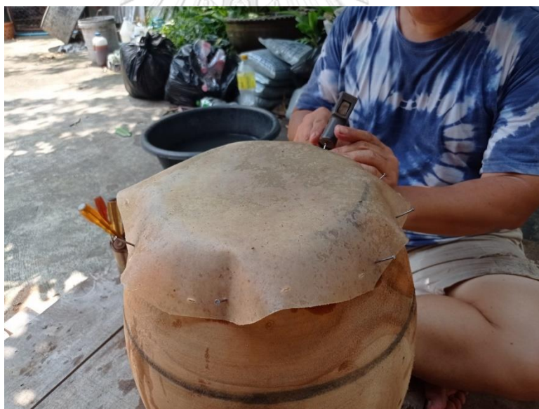
ภาพที่ 119 การใช้ตะปู 1 นิ้วตอกหน้าตะโพนเพื่อขึ้นรูปกับหุ่นกลอง (ที่มา: ผู้วิจัย บันทึกภาพเมื่อวันที่ 7 สิงหาคม พ.ศ. 2564)
