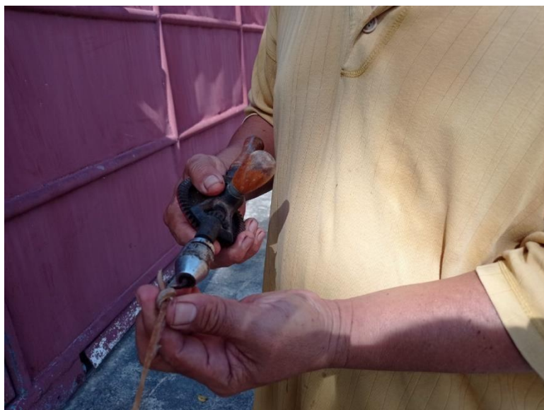
ภาพที่ 82 การผูกส่วนปลายข้างหนึ่งของไส้ละมานเข้ากับหัวตะขอ (ที่มา: ผู้วิจัย บันทึกภาพเมื่อวันที่ 9 สิงหาคม พ.ศ. 2564)
