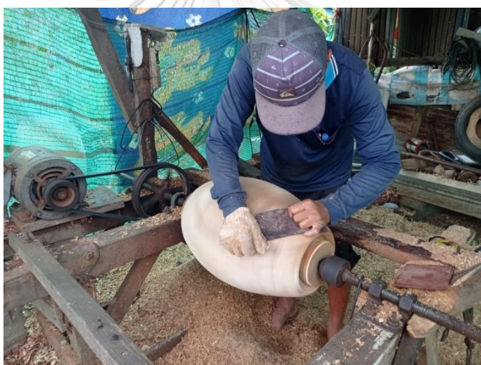
ภาพที่ 66 การขัดหุ่นตะโพนหลังเสร็จสิ้นการกลึง (ที่มา: ผู้วิจัย บันทึกภาพเมื่อวันที่ 6 สิงหาคม พ.ศ. 2564)
