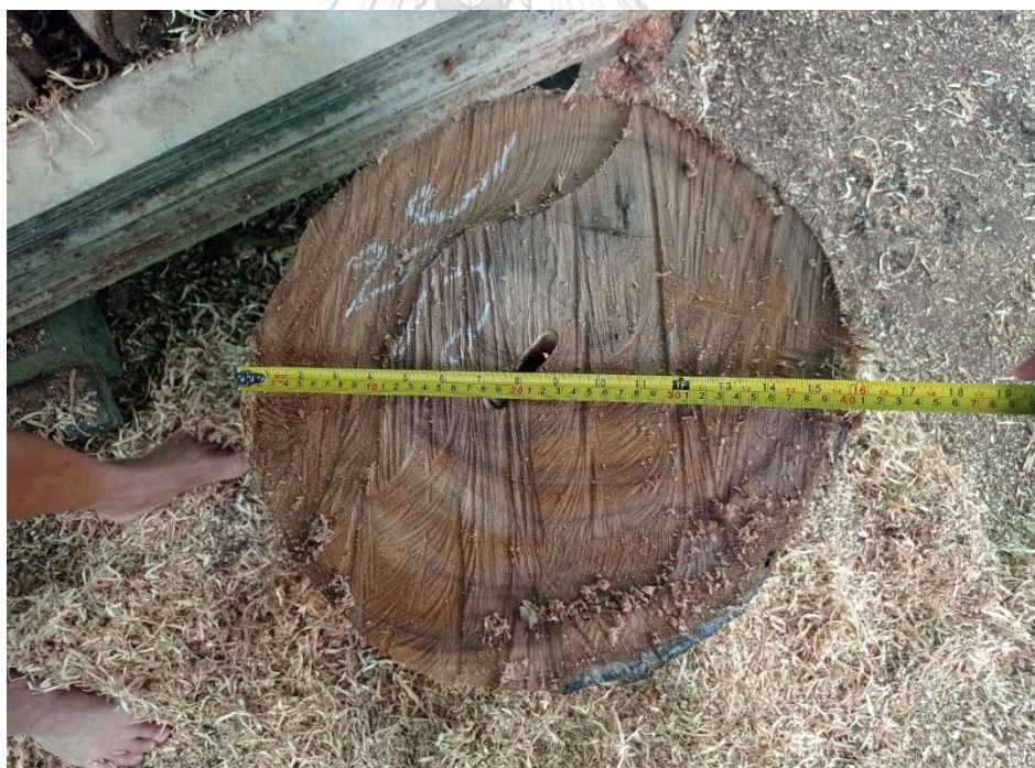
ภาพที่ 27 การวัดเส้นผ่านศูนย์กลางของไม้ซุงจามจรี (ที่มา: ผู้วิจัย บันทึกภาพเมื่อวันที่ 6 สิงหาคม พ.ศ. 2564)
