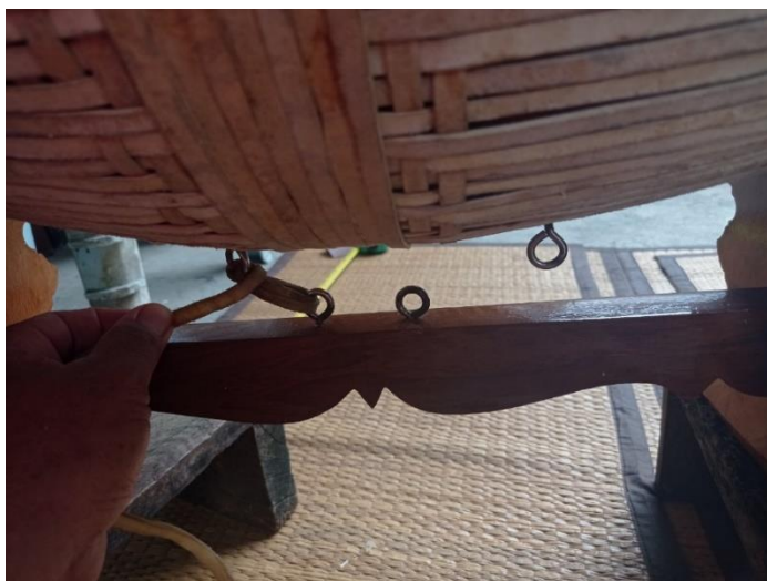
ภาพที่ 160 การร้อยหนังระหว่างห่วงฝิ่งของหุ่นตะโพนและฝิ่งของเท้าตะโพน 3 ทบ (ที่มา: ผู้วิจัย บันทึกภาพเมื่อวันที่ 23 สิงหาคม พ.ศ. 2564)
