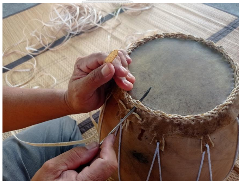
ภาพที่ 137 การใช้ไขควงแทงช่องใส่ลวดมวนเพื่อการร้อยหนังสือ (ที่มา: ผู้วิจัย บันทึกภาพเมื่อวันที่ 12 สิงหาคม พ.ศ. 2564)
