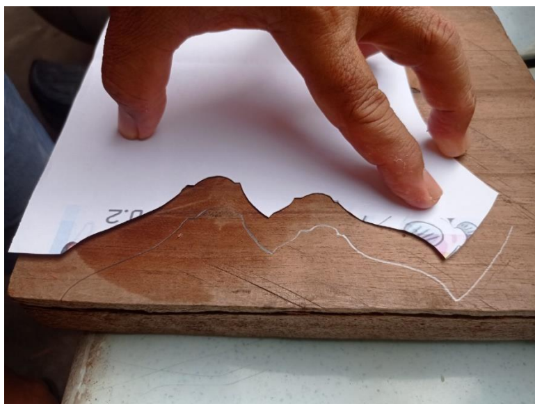
ภาพที่ 113 การร่างแผ่นไม้ให้เป็นรูปทรงเท้าตะโพน (ที่มา: ผู้วิจัย บันทึกภาพเมื่อวันที่ 21 สิงหาคม พ.ศ. 2564)
