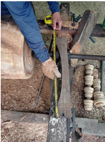
ภาพที่ 60 การวัดเส้นผ่านศูนย์กลางหน้าตัดหุ่นตะโปน (ที่มา: ผู้วิจัย บันทึกภาพเมื่อวันที่ 6 สิงหาคม พ.ศ. 2564)
