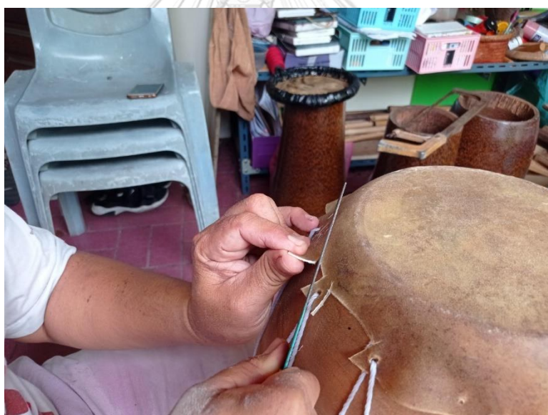
ภาพที่ 125 การตัดหน้าตะโพนส่วนเกินออก (ที่มา: ผู้วิจัย บันทึกภาพเมื่อวันที่ 7 สิงหาคม พ.ศ. 2564)
