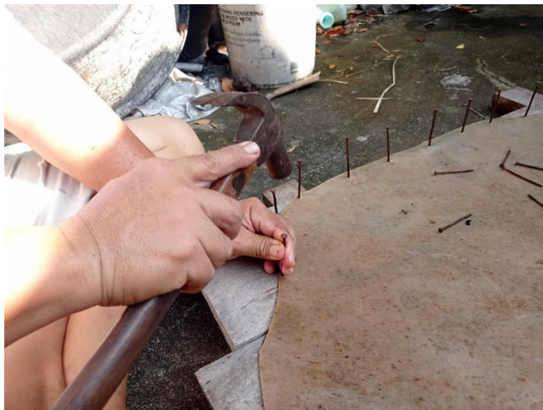
ภาพที่ 94 การตอกตะปูครั้งที่ 2 ให้ทะลุลงไปยังแผ่นกระดาษกาวหนัง (ที่มา: ผู้วิจัย บันทึกภาพเมื่อวันที่ 7 สิงหาคม พ.ศ. 2564)
