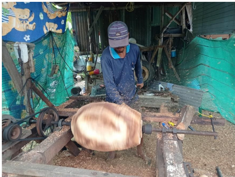
ภาพที่ 61 การกลึงหัวท้ายให้เป็นรูปทรงหุ้มตะโพน (ที่มา: ผู้วิจัย บันทึกภาพเมื่อวันที่ 6 สิงหาคม พ.ศ. 2564)
