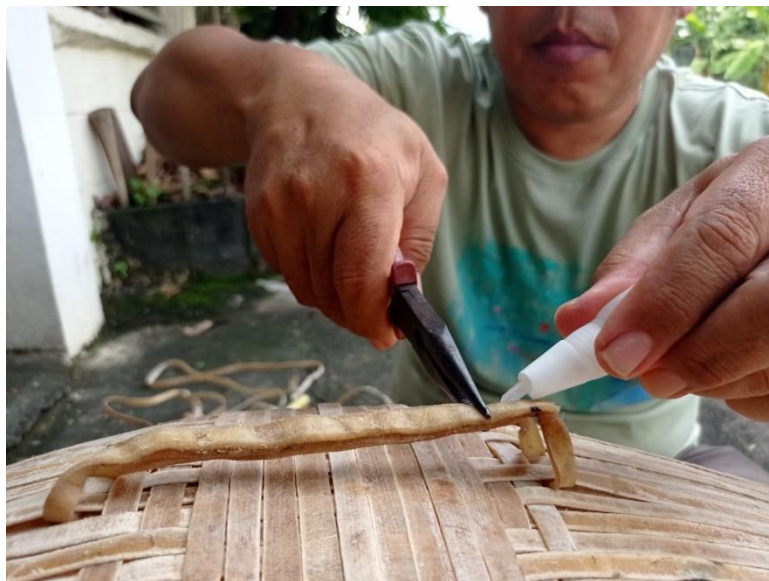
ภาพที่ 156 การหนีบหนังเรียดให้ได้รูปทรงเป็นหูหิ้วด้วยคีมปากแหลมและการหยอดกาวร้อน (ที่มา: ผู้วิจัย บันทึกภาพเมื่อวันที่ 23 สิงหาคม พ.ศ. 2564)
