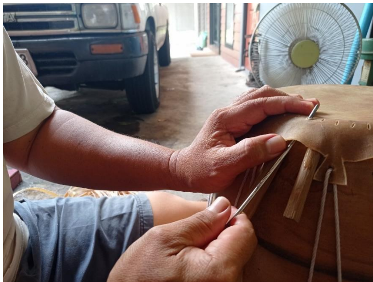
ภาพที่ 130 การแทงช่องใส่ละมานเพื่อร้อยเข้า (ที่มา: ผู้วิจัย บันทึกภาพเมื่อวันที่ 12 สิงหาคม พ.ศ. 2564)
