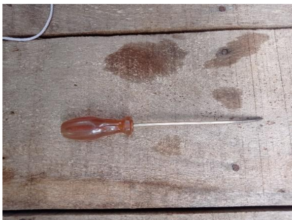
ภาพที่ 49 ไขควงสำหรับแทงช่องใส่ตะมาน (ที่มา: ผู้วิจัย บันทึกภาพเมื่อวันที่ 29 กรกฎาคม พ.ศ. 2564)
