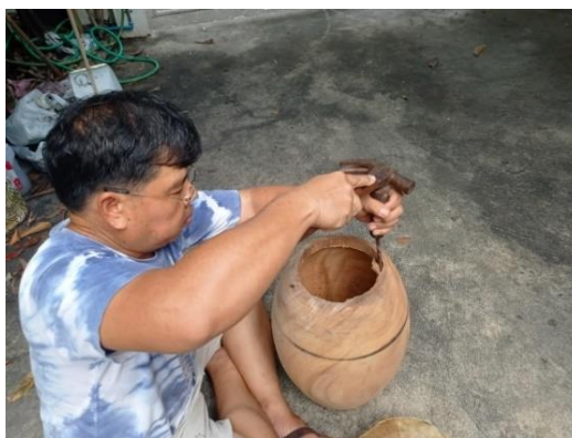
ภาพที่ 172 การเจาะขอบของหุ่นกลองส่วนที่เรียกว่า ปากนกแก้ว ออกจากหุ่นกลอง (ที่มา: ผู้วิจัย บันทึกภาพเมื่อวันที่ 7 สิงหาคม พ.ศ. 2564)
