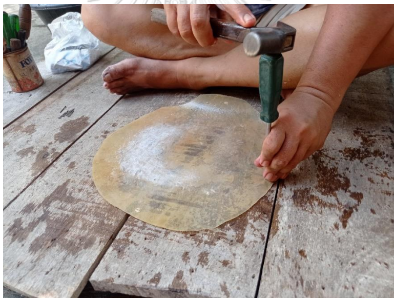
ภาพที่ 118 การใช้ไขควงหัวแบนตอกทำช่องสำหรับสอดเชือก (ที่มา: ผู้วิจัย บันทึกภาพเมื่อวันที่ 7 สิงหาคม พ.ศ. 2564)
