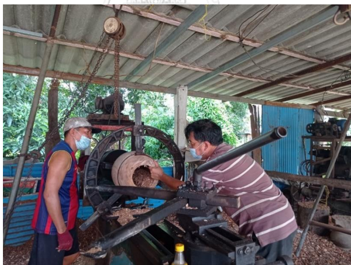
ภาพที่ 71 ครูภูมิใจ รั้นเร่งควบคุมการคว้านหุ่นตะโพน (ที่มา: ผู้วิจัย บันทึกภาพเมื่อวันที่ 6 สิงหาคม พ.ศ. 2564)
