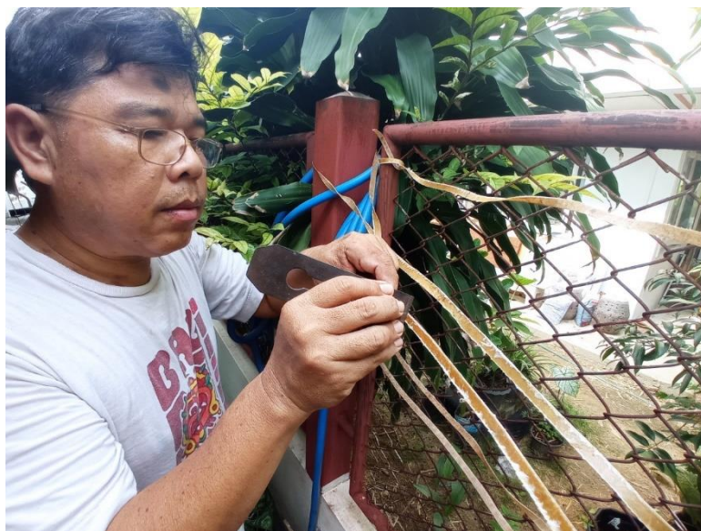
ภาพที่ 105 การใช้ใบกบไสไม้ชุดหนังเรียด (ที่มา: ผู้วิจัย บันทึกภาพเมื่อวันที่ 19 กันยายน พ.ศ. 2564)
