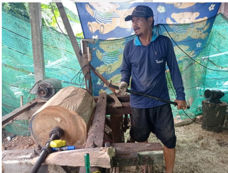
ภาพที่ 57 การเริ่มต้นกลึงหุ่นตะโพน (ที่มา: ผู้วิจัย บันทึกภาพเมื่อวันที่ 6 สิงหาคม พ.ศ. 2564)
