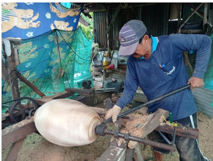
ภาพที่ 65 การบากที่ด้านหัวและท้ายของหุ่นตะโพน (ที่มา: ผู้วิจัย บันทึกภาพเมื่อวันที่ 6 สิงหาคม พ.ศ. 2564)
