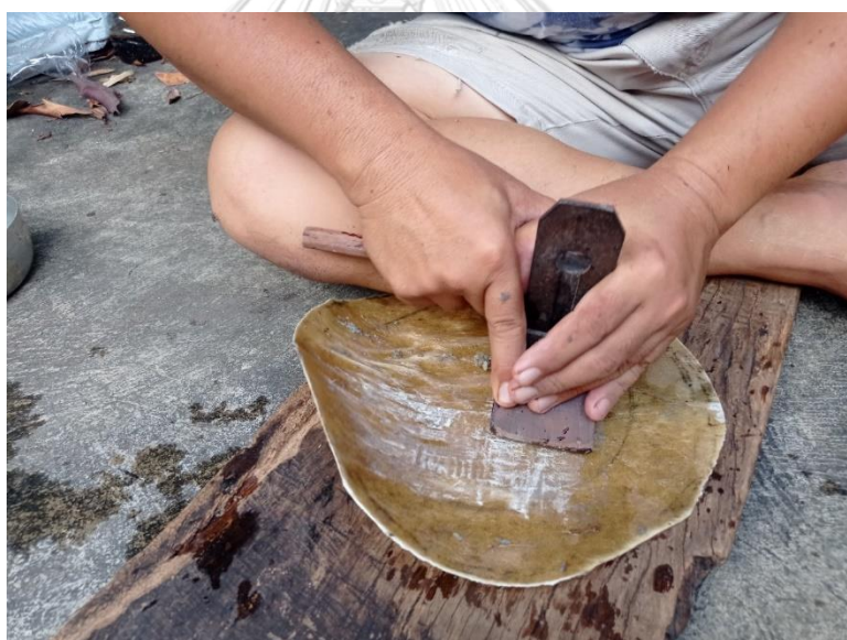
ภาพที่ 112 การไสหนังเพื่อปรับความหนาของหน้าตะโพนให้เสมอกัน (ที่มา: ผู้วิจัย บันทึกภาพเมื่อวันที่ 7 สิงหาคม พ.ศ. 2564)
