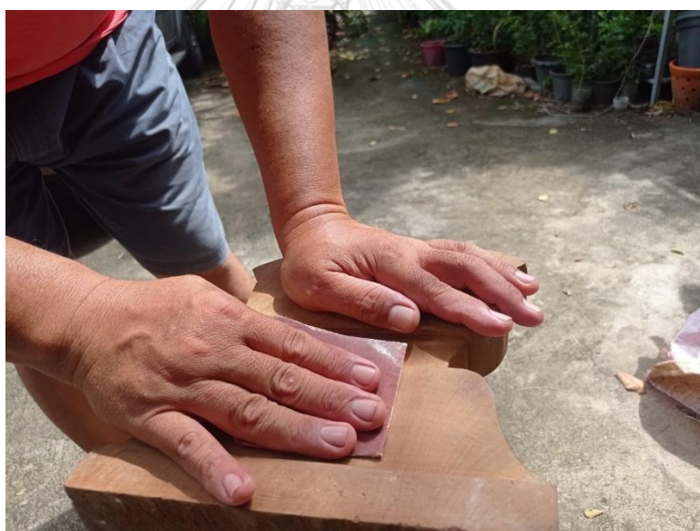
ภาพที่ 116 การขัดตกแต่งเท้าตะโพน (ที่มา: ผู้วิจัย บันทึกภาพเมื่อวันที่ 21 สิงหาคม พ.ศ. 2564)
