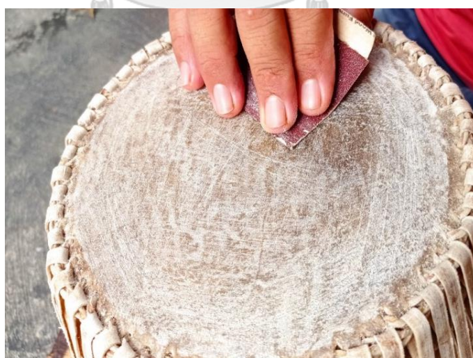
ภาพที่ 163 การใช้กระดาษทรายขัดหน้าตะโพน (ที่มา: ผู้วิจัย บันทึกภาพเมื่อวันที่ 23 สิงหาคม พ.ศ. 2564)
