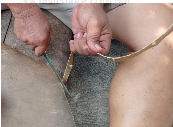
ภาพที่ 100 การตัดหนังส่วนขอบที่มีรอยตะปูออก (ที่มา: ผู้วิจัย บันทึกภาพเมื่อวันที่ 7 สิงหาคม พ.ศ. 2564)
