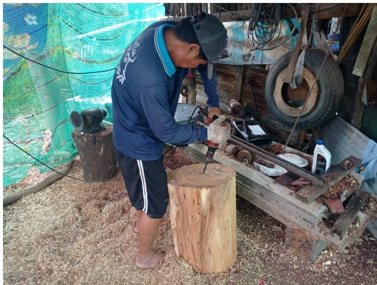
ภาพที่ 54 การเจาะรูที่จุดศูนย์กลางของไม้เพื่อเตรียมนำขึ้นแท่นกลึง (ที่มา: ผู้วิจัย บันทึกภาพเมื่อวันที่ 6 สิงหาคม พ.ศ. 2564)
