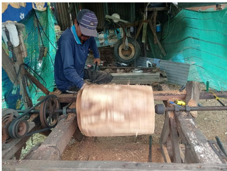
ภาพที่ 58 การกลึงเพื่อปรับรูปทรงของไม้ให้เป็นทรงกระบอก (ที่มา: ผู้วิจัย บันทึกภาพเมื่อวันที่ 6 สิงหาคม พ.ศ. 2564)
