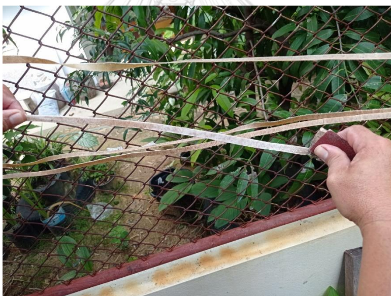
ภาพที่ 106 การใช้กระดาษทรายขัดหนังเรียด (ที่มา: ผู้วิจัย บันทึกภาพเมื่อวันที่ 19 กันยายน พ.ศ. 2564)
