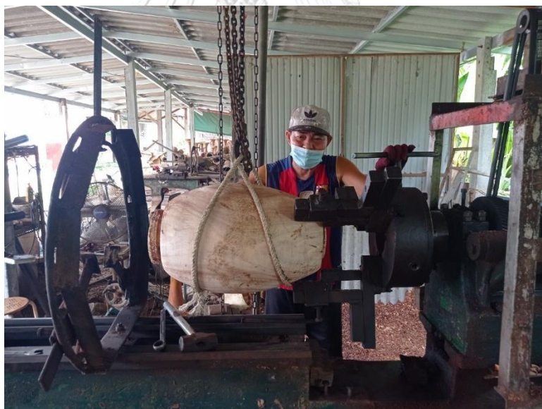
ภาพที่ 68 การยึดหุ่นตะโพนไว้บนแท่นคว้าน (ที่มา: ผู้วิจัย บันทึกภาพเมื่อวันที่ 6 สิงหาคม พ.ศ. 2564)
