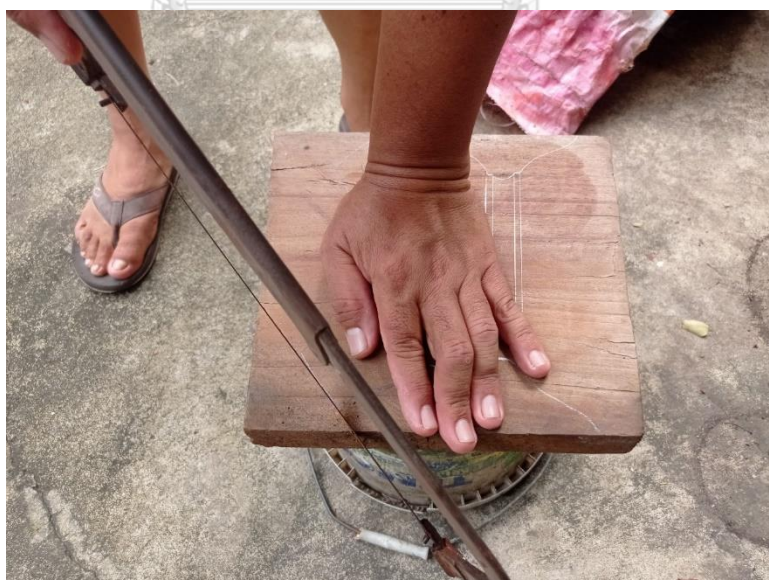
ภาพที่ 114 การเลื่อยไม้แผ่นให้เป็นรูปทรงเท้าตะโพน (ที่มา: ผู้วิจัย บันทึกภาพเมื่อวันที่ 21 สิงหาคม พ.ศ. 2564)
