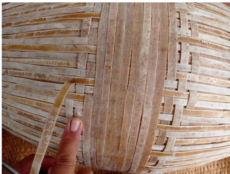
ภาพที่ 154 การขัดรัดดอกให้สมมาตรกันทั้งสองฝั่ง (ที่มา: ผู้วิจัย บันทึกภาพเมื่อวันที่ 22 สิงหาคม พ.ศ. 2564)
