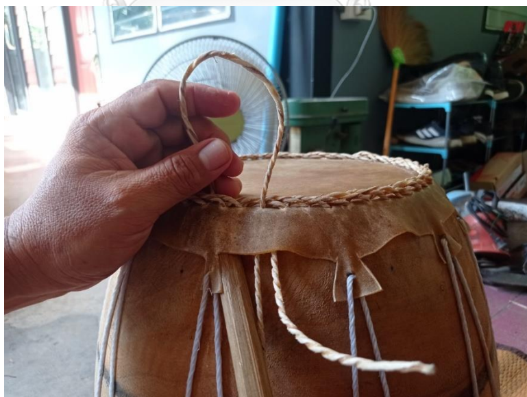
ภาพที่ 134 วิธีการร้อยใส่ละมานแบบ “ออกหน้า” (ที่มา: ผู้วิจัย บันทึกภาพเมื่อวันที่ 12 สิงหาคม พ.ศ. 2564)
