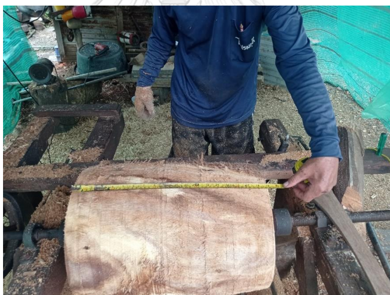
ภาพที่ 59 การวัดความยาวของท่อนตะโพน (ที่มา: ผู้วิจัย บันทึกภาพเมื่อวันที่ 6 สิงหาคม พ.ศ. 2564)
