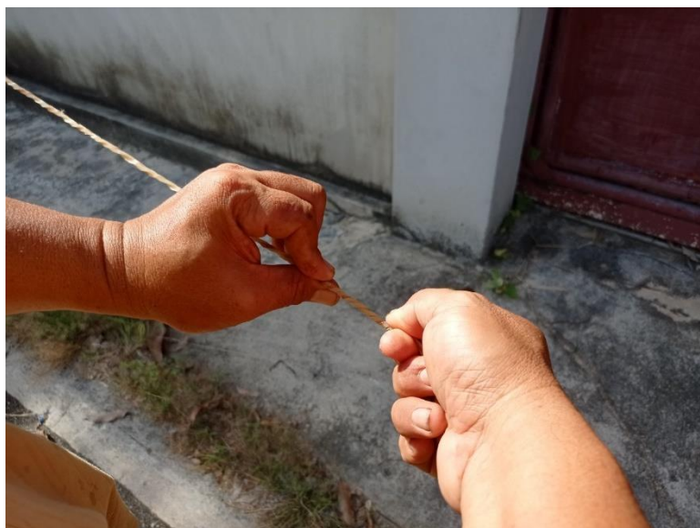
ภาพที่ 84 การบิดปรับรูปทรงของไส้ละมานให้เข้าเกลียว
