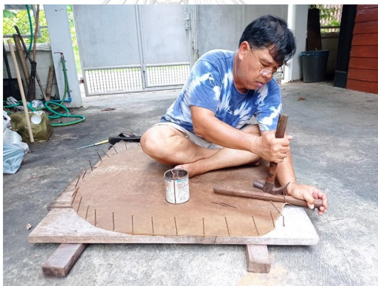
ภาพที่ 99 การถอนตะปูออกหลังจากหนังแห้งดีแล้ว (ที่มา: ผู้วิจัย บันทึกภาพเมื่อวันที่ 7 สิงหาคม พ.ศ. 2564)
