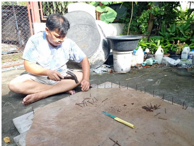
ภาพที่ 96 การตอกตะปูรอบแผ่นหนัง (ที่มา: ผู้วิจัย บันทึกภาพเมื่อวันที่ 7 สิงหาคม พ.ศ. 2564)
