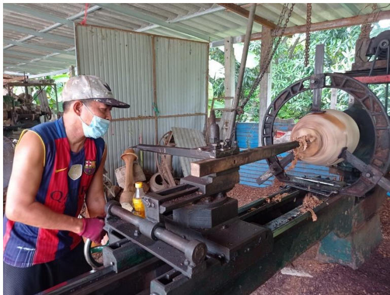
ภาพที่ 69 การใช้เครื่องเจาะทำโพรงด้านในหุ่นตะโพน (ที่มา: ผู้วิจัย บันทึกภาพเมื่อวันที่ 6 สิงหาคม พ.ศ. 2564)
