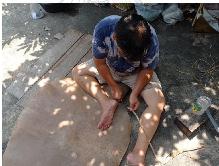
ภาพที่ 102 การเรียดหนังให้เป็นเส้น (ที่มา: ผู้วิจัย บันทึกภาพเมื่อวันที่ 7 สิงหาคม พ.ศ. 2564)
