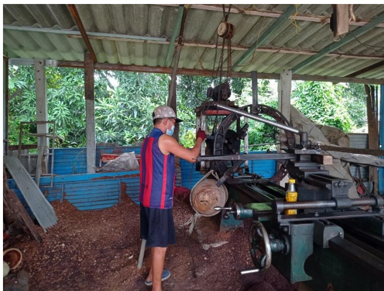
ภาพที่ 67 การชักกรอกเพื่อนำหุ่นตะโพนขึ้นบนแท่นคว้าน (ที่มา: ผู้วิจัย บันทึกภาพเมื่อวันที่ 6 สิงหาคม พ.ศ. 2564)
