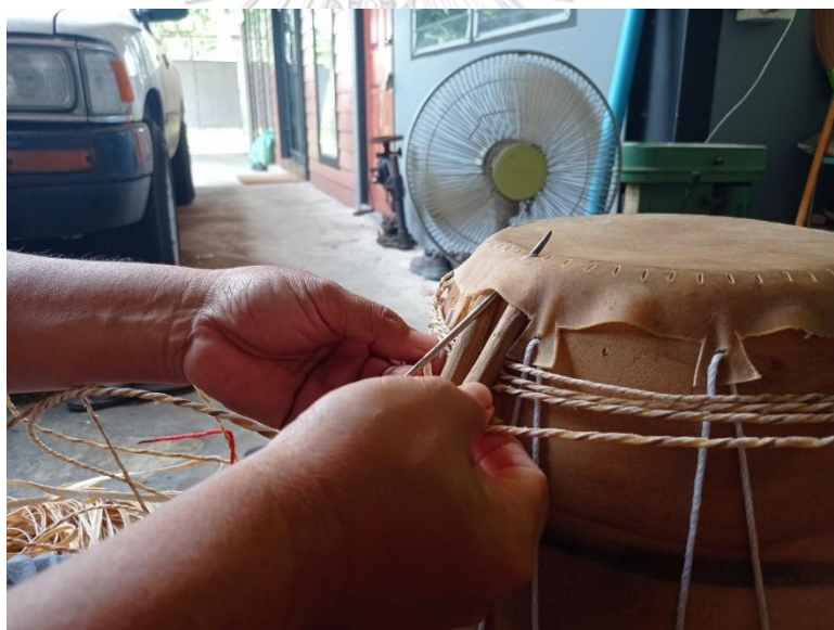
ภาพที่ 129 การวัดความยาวไส้ละมาน (ที่มา: ผู้วิจัย บันทึกภาพเมื่อวันที่ 12 สิงหาคม พ.ศ. 2564)
