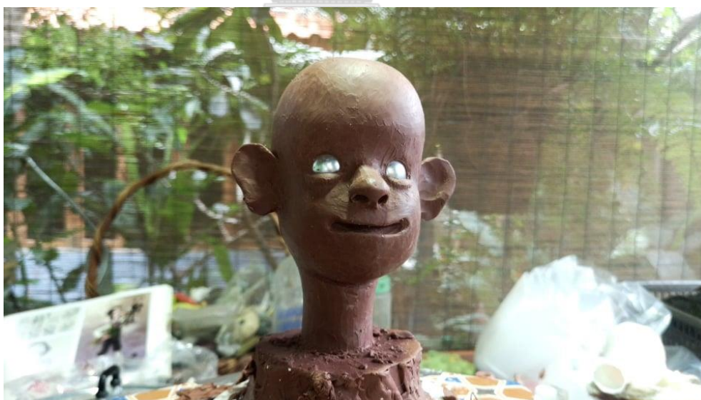
ภาพที่ 91 ภาพถ่ายการขึ้นรูปหัวหุ่นด้วยการปั้นจากดินน้ำมันโดยลูกตาใช้วัสดุลูกปิดพลาสติกเพื่อวางตำแหน่งของกลไก โดยหลังขั้นตอนนี้จะนำไปสู่ขั้นตอนการทำแม่พิมพ์หัวหุ่นรอบแรก แล้วหล่อต้นแบบเป็นปูน ทำการขัดแต่งแล้วทำพิมพ์สมบูรณ์อีกครั้งด้วยยางซิลิโคน ซึ่งเป็นรูปแบบการสร้างสรรค์หุ่นดั้งเดิมของทีมงานบ้านตุ๊กกะตุ่น บันทึกภาพโดยผู้วิจัย วันที่ 15 กรกฎาคม 2564
