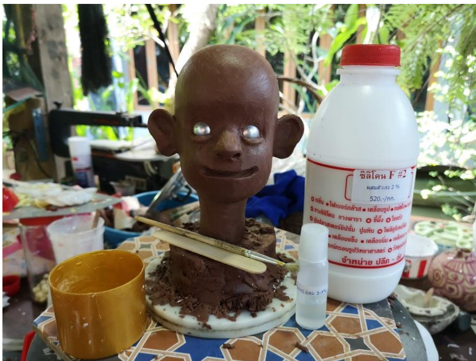
ภาพที่ 92 ภาพถ่ายอุปกรณ์การทำแม่พิมพ์หัวหุ่นในรูปแบบการปั้นและขึ้นรูปด้วยกรรมวิธีดั้งเดิมของทีมงานบ้านตุ๊กกะตุ่นหุ่นกระบอกไทย ประกอบด้วย น้ำยางซิลิโคน ตัวแรงแข็งยางซิลิโคน ไม้และฟู่กัน สำหรับผสมและปาดน้ำยาง บันทึกภาพโดยผู้วิจัย วันที่ 15 กรกฎาคม 2564
