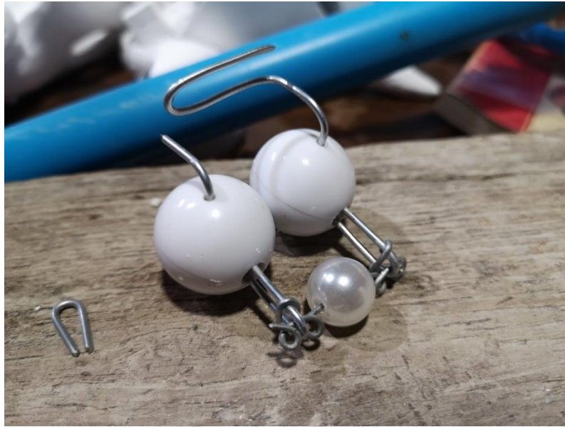
ภาพที่ 98 ภาพถ่ายกลไกการเคลื่อนไหวลูกตาในรูปแบบดั้งเดิมของหัวหุ่นบ้านตุ๊กกะตุ่น หุ่นกระบอกไทย ซึ่งนำมาผสมผสานกับหัวหุ่นที่มีการบังคับด้วยระบบเซอร์โวมอเตอร์ โดยการสร้างสรรค์กลไกการเคลื่อนไหวภายในหัวหุ่นกระบอกเรื่องพระพุทธเจ้า บันทึกภาพโดยผู้วิจัย วันที่ 20 กรกฎาคม 2564
