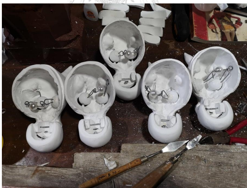
ภาพที่ 101 ภาพถ่ายกลไกภายในหัวหุ่นแพะที่ผลิตจากปูนปลาสเตอร์หล่อกลวงประกอบกับการเคลื่อนไหวลูกตาหุ่นที่ผลิตจากลูกปัดขนาดใหญ่ด้วยการถ่วงน้ำหนัก เพื่อให้ลูกตาสามารถกลอกตาไปซ้ายขวาได้ตามแรงโน้มถ่วง โดยหลังขั้นตอนการประกอบกลไกจะเข้าสู่ขั้นตอนการทำสีหัวหุ่น บันทึกภาพโดยผู้วิจัย วันที่ 19 กรกฎาคม 2564
