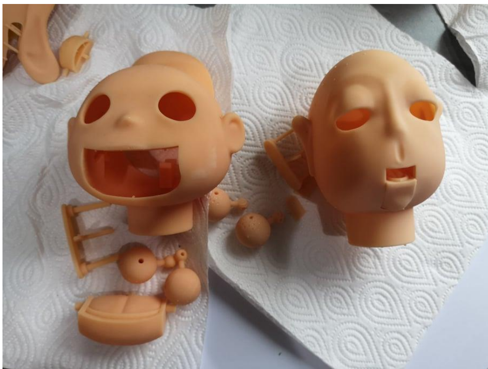
ภาพที่ 90 ภาพถ่ายหัวหุ่นและชิ้นส่วนกลไกภายในหัวหุ่นที่ผลิตจากวัสดุเรซินสีเนื้อด้วยระบบ 3D print บันทึกภาพโดยผู้วิจัย วันที่ 15 กรกฎาคม 2564
