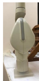
ง. แสดงการสวมลำกระบอกรังสีลงใน อุปกรณ์ล็อกลำกระบอกรังสี
