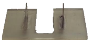
ก. แผ่นล็อกตำแหน่งแผ่นรับภาพรังสีดิจิตอล
