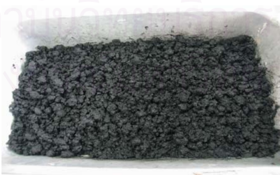
รูปที่ 4.2 เถ้าลอยชานอ้อยที่มีลักษณะเป็นก้อนเถ้าที่เปียก มีสีดำ
