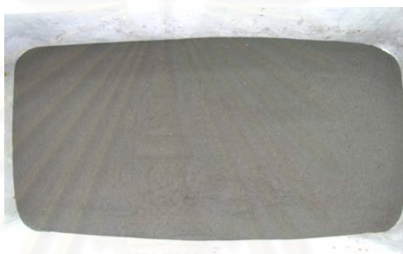
รูปที่ 4.1 เถ้าลอยถ่านหินที่ถูกจับไว้ด้วยเครื่องตกตะกอนไฟฟ้าสถิต
