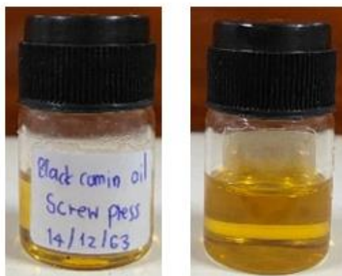
รูปที่ ก.2 น้ำมันที่สกัดจากเมล็ดเทียนดำด้วยวิธีการอัดแบบสกรู
