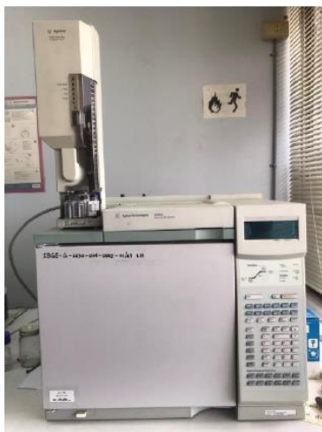
รูปที่ 3.8 เครื่องแก๊สโครมาโทกราฟ ยี่ห้อ Agilent รุ่น 6890N
