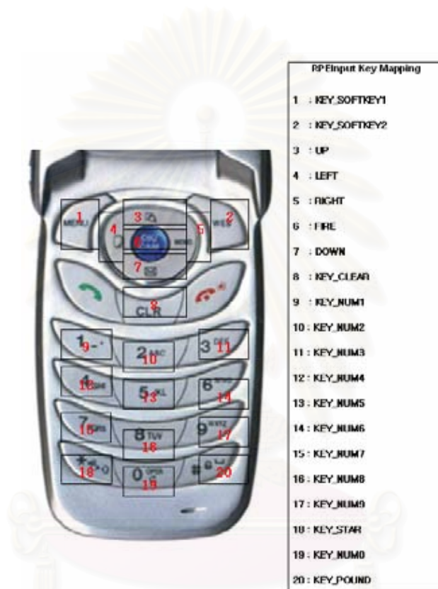
รูปที่ 3.4 รูปแสดงตำแหน่งของปุ่มบนโทรศัพท์เคลื่อนที่เทียบกับค่าตัวแปรคงที่ในคลาสส่วนการจัดการเหตุการณ์ของการรับข้อมูลเข้า
