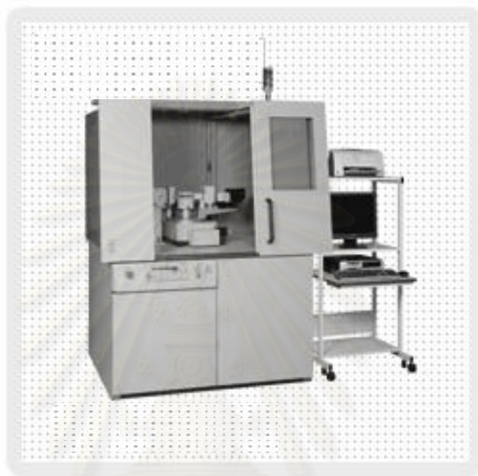
รูปที่ 3.7 เครื่องทดสอบเอ็กซ์เรย์ดิฟแฟรกชัน
