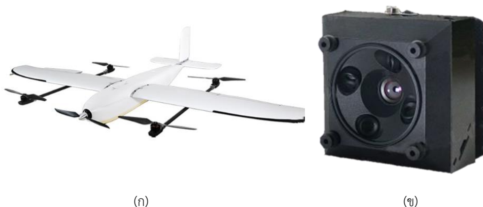
รูปที่ 11 (ก) ยูเอวีลูกผสมชนิดปีกตรึงและหลายโรเตอร์ (VTOL) รุ่น Loong 2160 VTOL ใช้ในการบินปฏิบัติภารกิจ (ข) กล้อง 3DM V3 ที่ใช้ในการบันทึกภาพถ่าย ((ก) ดัดแปลงจาก Foxtechfpv.com, 2020 และ (ข) ดัดแปลงจาก Foxtechfpv.com, 2019)
