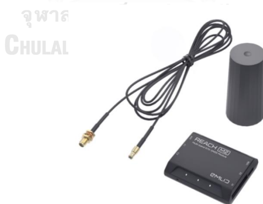
รูปที่ 12 อุปกรณ์รับสัญญาณดาวเทียมที่ใช้บนยูเอวี (ดัดแปลงจาก Mapgear.com, 2020)
