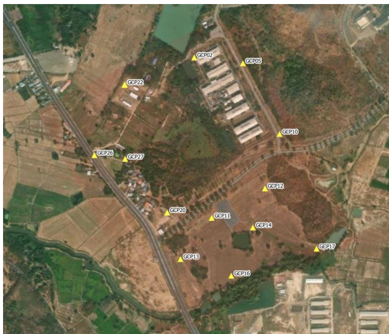
รูปที่ 20 การกระจายตัวของตำแหน่งจุดบังคับภาพถ่ายภาคพื้นดิน ที่ใช้ในการประมวลผลภายในงานวิจัย
