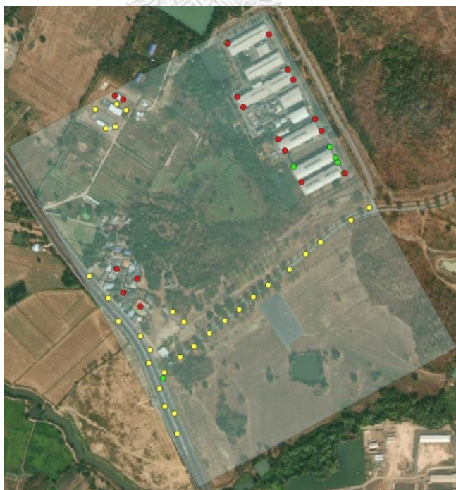
รูปที่ 34 ตำแหน่งการกระจายตัวของจุดที่ใช้ในการรังวัดค่าพิกัดสามมิติเพื่อเปรียบเทียบ
