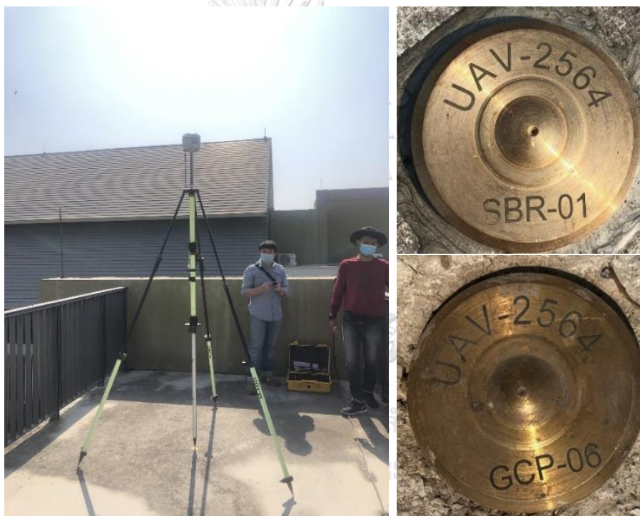
รูปที่ 13 การรับสัญญาณดาวเทียมบนหมุดสถานีฐานและตัวอย่างหัวหมุดทองเหลืองจุดบังคับภาพพื้นดิน
