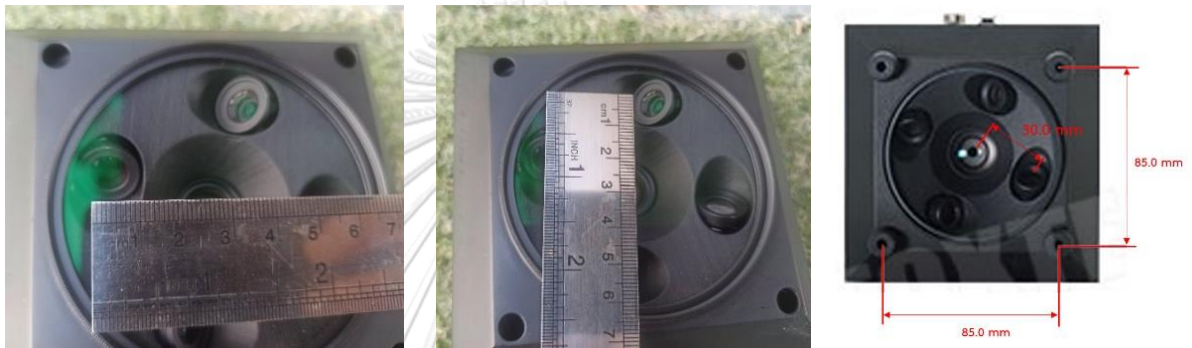
รูปที่ 18 การวัดระยะห่างจากกล้องกลางไปยังกล้องอื่น ๆ บนระบบกล้องหลายหัว
