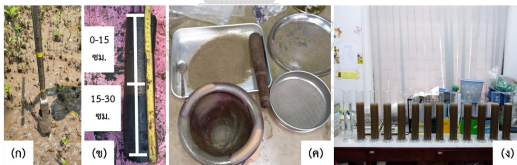
ภาพที่ 30 (ก) soil core ที่ใช้เก็บ (ข) ตัวอย่างดิน (ค) การเตรียมตัวอย่างดิน และ (ง) การวิเคราะห์เนื้อดินด้วยวิธี hydrometer method
