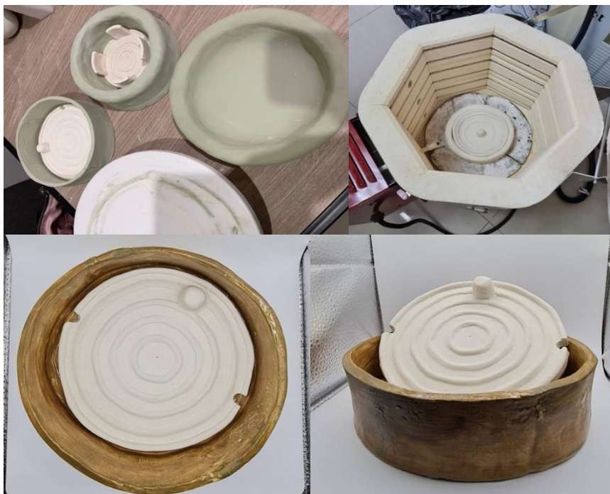
รูปที่ 5.5 ชามอาหารสุนัขและจานรองกลิ้งหลังจากผ่านการขึ้นรูป ลงสีและลงเคลือบในส่วนของชามอาหารและเผาขึ้นรูปในเตาเผาด้วยความร้อน 1,200 องศาเซลเซียส ขึ้นไฟ 30 นาที
