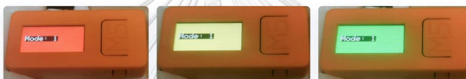
ภาพที่ 5.27 การเปลี่ยนสีของหลอดไฟ LED บนกล่องไอโอทีแสดงผลในรูปแบบแสง และสั่นหลังปรับปรุง
