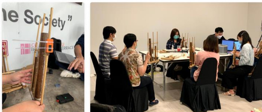
ภาพที่ 5.26 การทดสอบร่วมกับผู้เชี่ยวชาญและการหาตำแหน่งที่เหมาะสมของกล่องรับสัญญาณ การสั่นสะเทือนบนเครื่องดนตรีอังกฤษ
