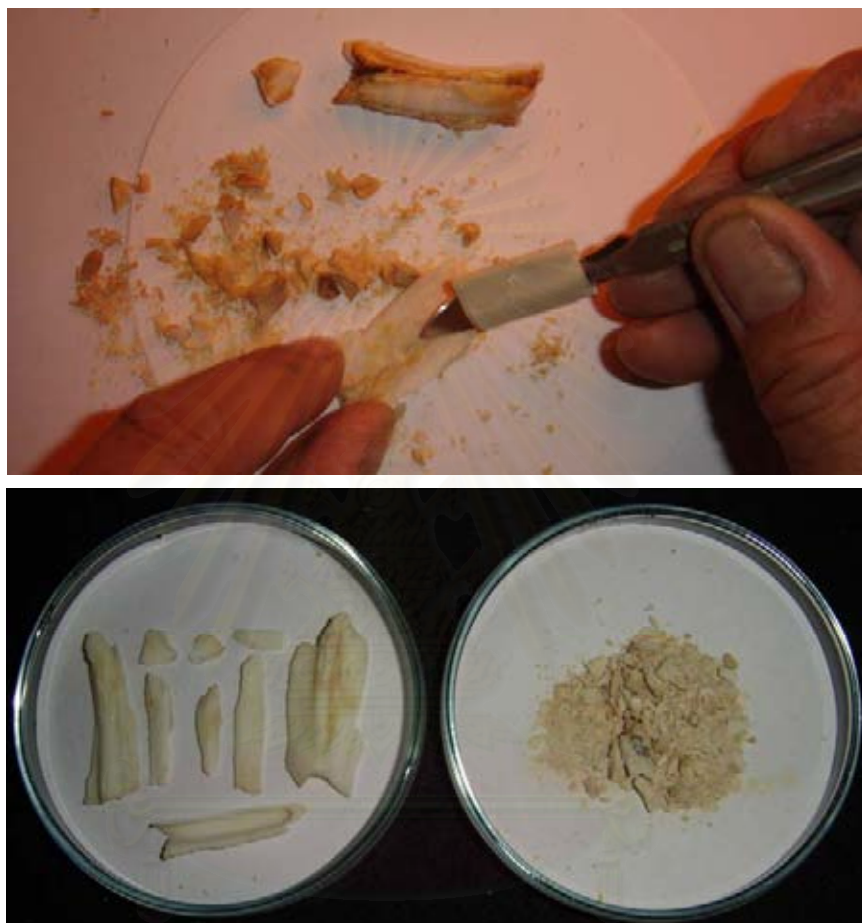
รูปที่ 3.7 แสดงการขูดหินปูนและเนื้อฟันออกจาก Enamel ของตัวอย่าง
