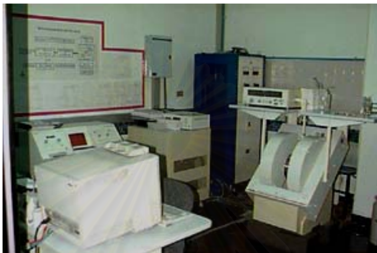
รูปที่ 2.10 เครื่อง ESR Spectrometer และระบบควบคุม [22]
