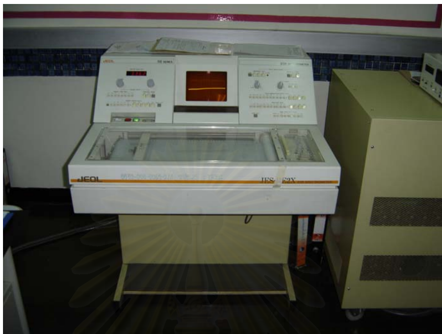
รูปที่ ค 2 เครื่องควบคุมป้อนสนามแม่เหล็ก
