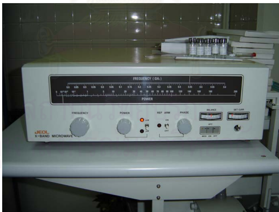
รูปที่ ค 3 Microwave Bridge ช่วง X – band
