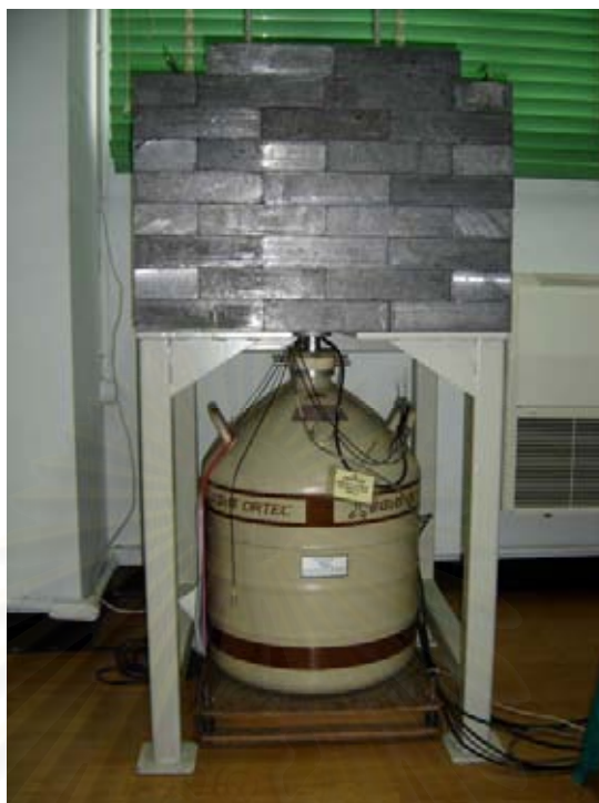
รูปที่ ๘ หัววัดรังสีแบบ HPGe ขนาด 76×76 mm
