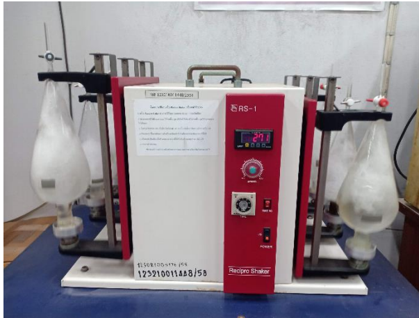
รูปที่ 3-3 การเขย่ากรวยแยกด้วยเครื่องเขย่า (Shaker) เพื่อสกัด DDPHs
