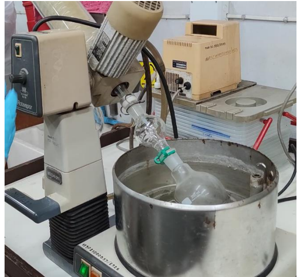
รูปที่ ค-5 ขั้นตอนลดปริมาตรด้วยเครื่อง Rotary Evaporator
