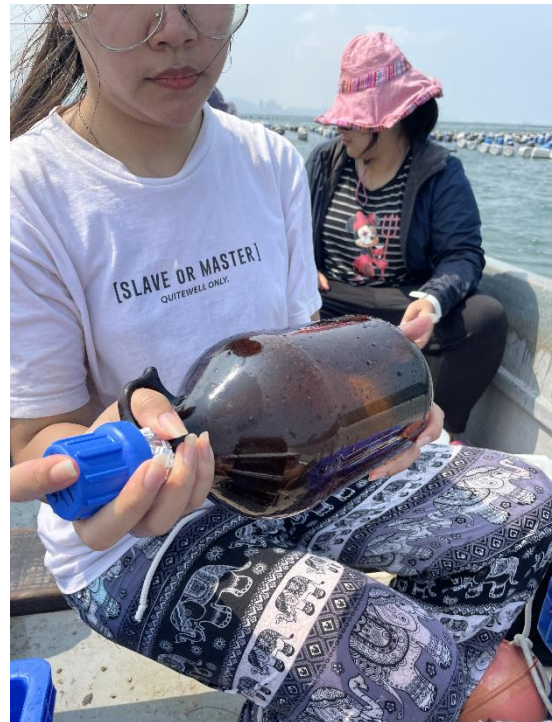
รูปที่ ค-3 เขย่าหลังจากใส่เฮกเซนเพื่อสกัดเบื้องต้น
