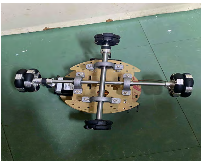
รูปที่ 3.7 ติดตั้งล้อตามหลักการฮาโลโนมิก ไดรฟ์
