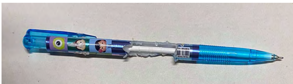
รูปที่ 3.9 การเจาะปากกาเพื่อนำเซอร์โวมอเตอร์มาควบคุมการเปิด ปิด
