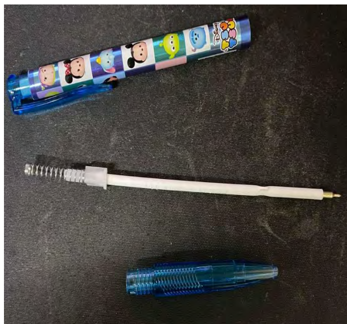
รูปที่ 3.8 การสลับสปริงและตัดปลายปากกาเพื่อให้สปริงต้านแรงกดปากกา
