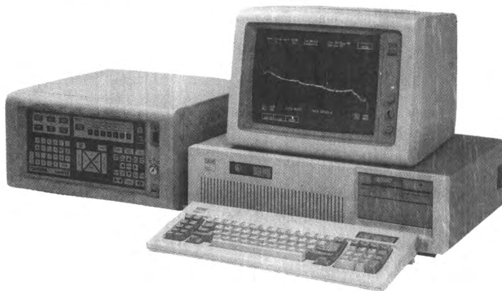
รูปที่ 11.34 แสดงเครื่อง Multichannel Analyzer ควบคู่กับเครื่อง IBM Personal Computer ซึ่งผลิตโดยบริษัท Canberra Industries, Inc.
