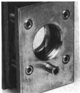
รูปที่ 4.10 แสดง sealed cell ที่มีความหนาคงที่
