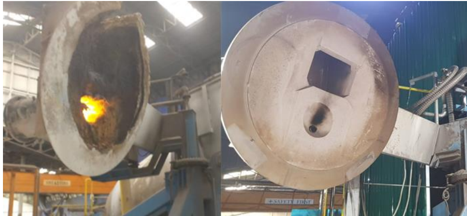
ภาพที่ 33 เปลี่ยน Burner แบบธรรมดา เป็นแบบ Oxygen burner
