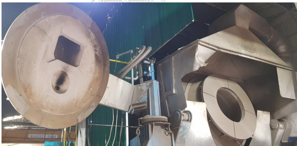
ภาพที่ 32 การติดตั้ง Hood ที่เตาหลอม Rotary
