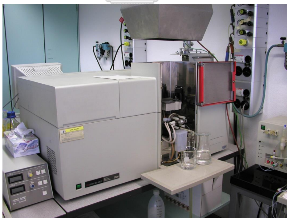
ภาพที่ 59 ตัวอย่างการวิเคราะห์ด้วยวิธี Grab sampling โดย flame atomic absorption spectroscopy (3111-B)
