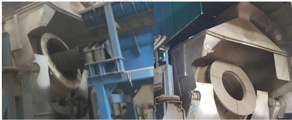
ภาพที่ 34 ลดขนาดช่องเปิดปากเตาให้เล็กลง เพื่อลดการฟุ้งกระจายของ Bucket ยังค้างอยู่ที่ปากช่องเปิด
