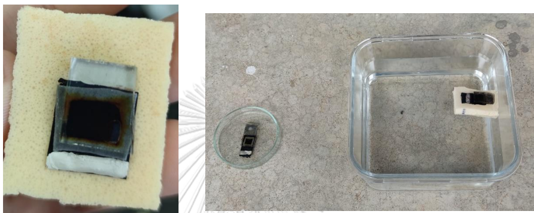
รูปที่ 3.8 เซลล์สุริยะชนิดสีย้อมไวแสงที่ใช้ขั้วไฟฟ้าวัดเป็นยางธรรมชาตินำไฟฟ้า
