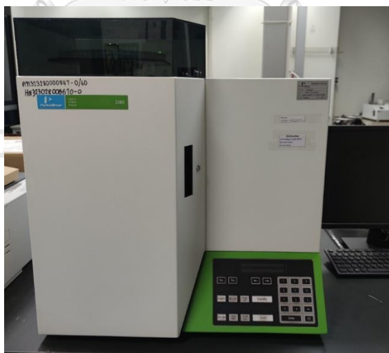
รูปที่ 3.17 เครื่องวิเคราะห์องค์ประกอบ CHN analyzer
