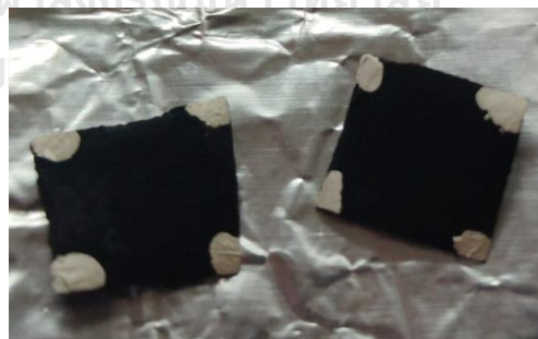
รูปที่ 3.11 การเตรียมตัวอย่างชิ้นงานก่อนนำไปวัดค่าการนำไฟฟ้าด้วยเทคนิคแวน เดอ พาวน์
