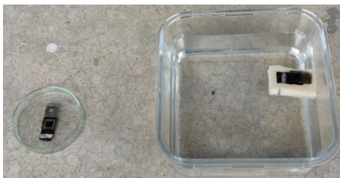
รูปที่ 4.19 การทดสอบอุณหภูมิน้ำต่ออุณหภูมิเซลล์สุริยะ
