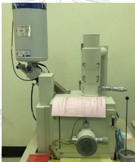
รูปที่ 3.12 กล้องจุลทรรศน์อิเล็กตรอนแบบส่องกราด (scanning electron microscope :SEM)
