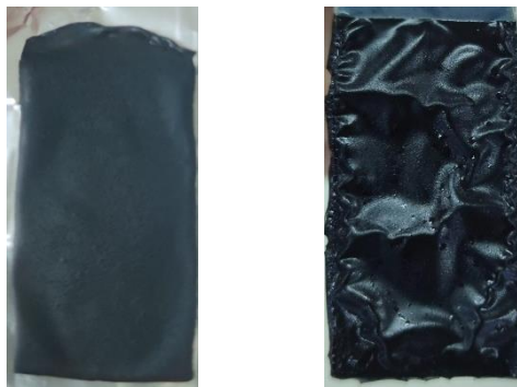
รูปที่ 4.4 ลักษณะของยางคอมพอสิตที่ความต่างศักย์ 4 (ซ้าย) และ 7 (ขวา) โวลต์
