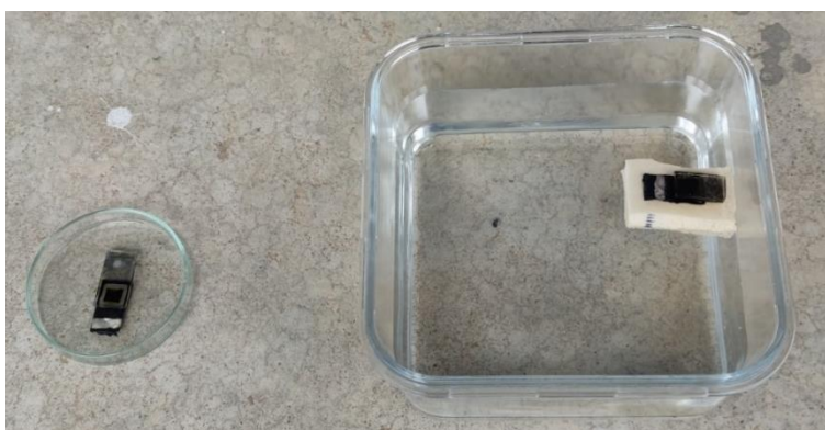
รูปที่ 3.18 การวิเคราะห์ผลต่างอุณหภูมิของเซลล์สุริยะชนิดสีย้อมไวแสงแบบลอยน้ำกับบนพื้น
