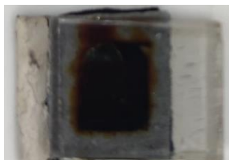
รูปที่ 3.6 เซลล์สุริยะชนิดสีย้อมไวแสงที่ใช้ขั้วไฟฟ้าพร้อมเป็นยางธรรมชาตินำไฟฟ้า
