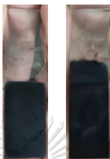
รูปที่ 3.3 ขั้วยางธรรมชาติผสม PEDOT:PSS บนกระจกนำไฟฟ้าก่อน (ซ้าย) และหลังเกิดพอลิไฟโรลพอลิเมอร์ไรเซชันของพอลิไฟโรล (ขวา)
