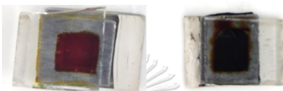
รูปที่ 4.16 เซลล์สุริยะชนิดสีย้อมไวแสงมาตรฐาน (ซ้าย), เซลล์สุริยะชนิดสีย้อมไวแสงที่นำสายธรรมชาติมาไฟฟ้ามาเป็นขั้วไฟฟ้าร่วม (ขวา)
