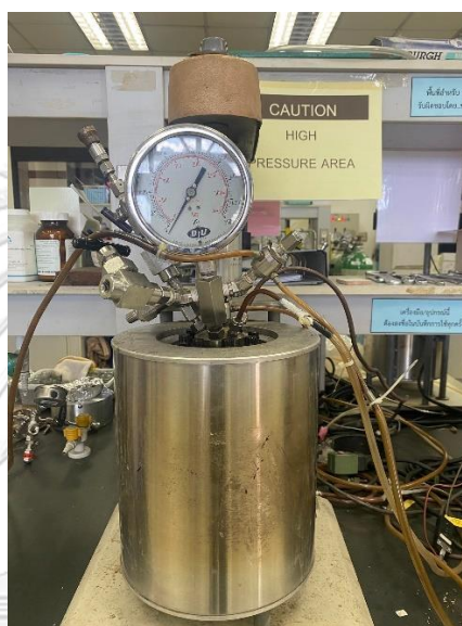
รูปที่ 3.1 เครื่องปฏิกรณ์ PARR Reactor Model 4848X
