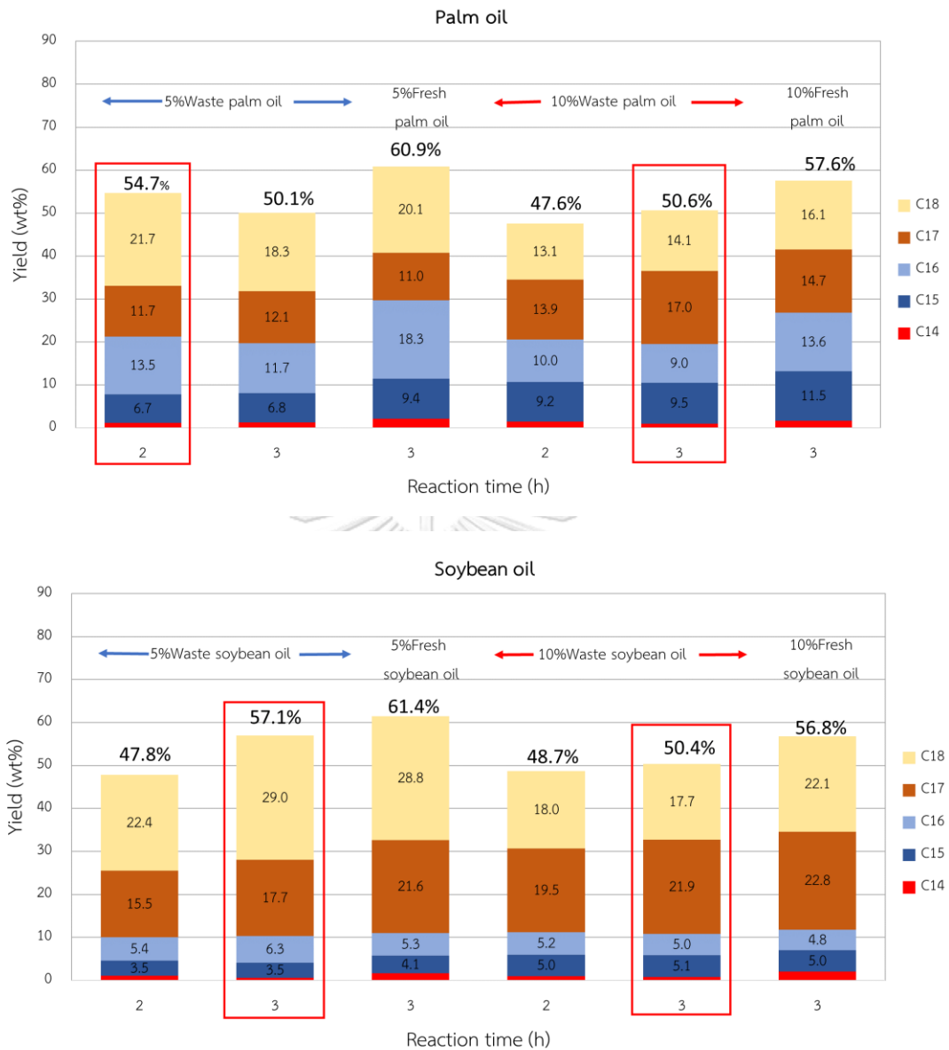
รูปที่ 4.2 ผลของเวลาและความเข้มข้นต่อร้อยละผลได้ของผลิตภัณฑ์ความเข้มข้นของน้ำมันปาล์ม และน้ำมันถั่วเหลืองใช้แล้วร้อยละ 5-10 โดยน้ำหนักของสารละลาย ภาวะการทดลอง: อุณหภูมิ 300 องศาเซลเซียส ความดันไฮโดรเจนเริ่มต้น 40 บาร์ เวลา 2-3 ชั่วโมง ความเข้มข้นของ สารตั้งต้นร้อยละ 5-10 โดยน้ำหนักของสารละลาย ตัวเร่งปฏิกิริยา 0.2-NiMoS 2 อัตราส่วนของตัวเร่งปฏิกิริยาต่อสารตั้งต้นที่ 0.1 (w/w)
