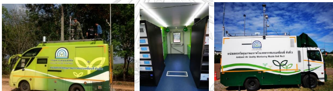
รูปที่ 10 หน่วยตรวจวัดคุณภาพอากาศแบบเคลื่อนที่
