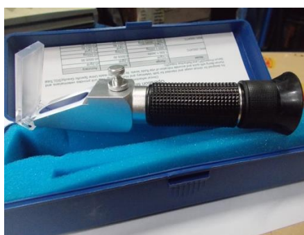
รูปที่ 17 เครื่องวัดค่าความถ่วงจำเพาะในปัสสาวะ
