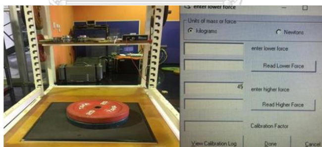
รูปที่ 4 แสดงการวางแผ่นน้ำหนักลงบนแผ่นรับแรงกระแทก
