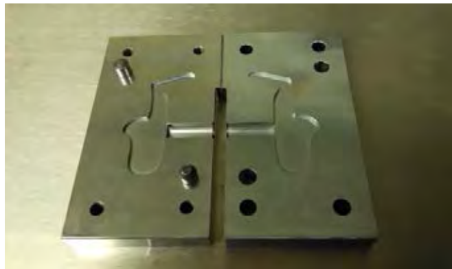
รูปที่ 3.3 แม่พิมพ์สำหรับฉีดขึ้นงานรูปแซกโซโฟน
