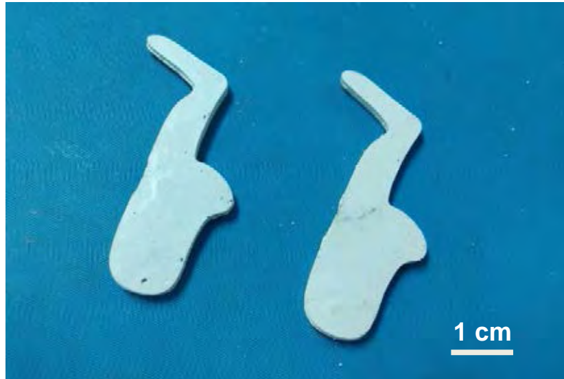
รูปที่ 4.7 ชิ้นงานต้นแบบรูปแฮกโซโฟนที่ได้จากกระบวนการฉีดขึ้นรูปวัสดุผง
