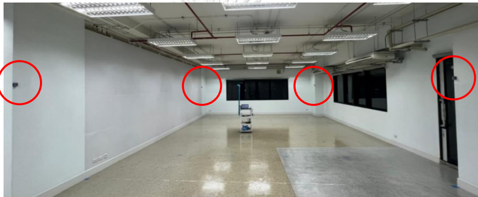
รูปที่ 5.9 สถานที่ทดสอบการปรับปรุงค่าความผิดพลาดจากการระบุตำแหน่งบนระนาบ 2 มิติ
