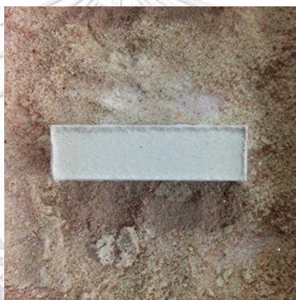
รูปที่ 3.4 ชิ้นงานของผงแก้วที่ผ่านการอัด
