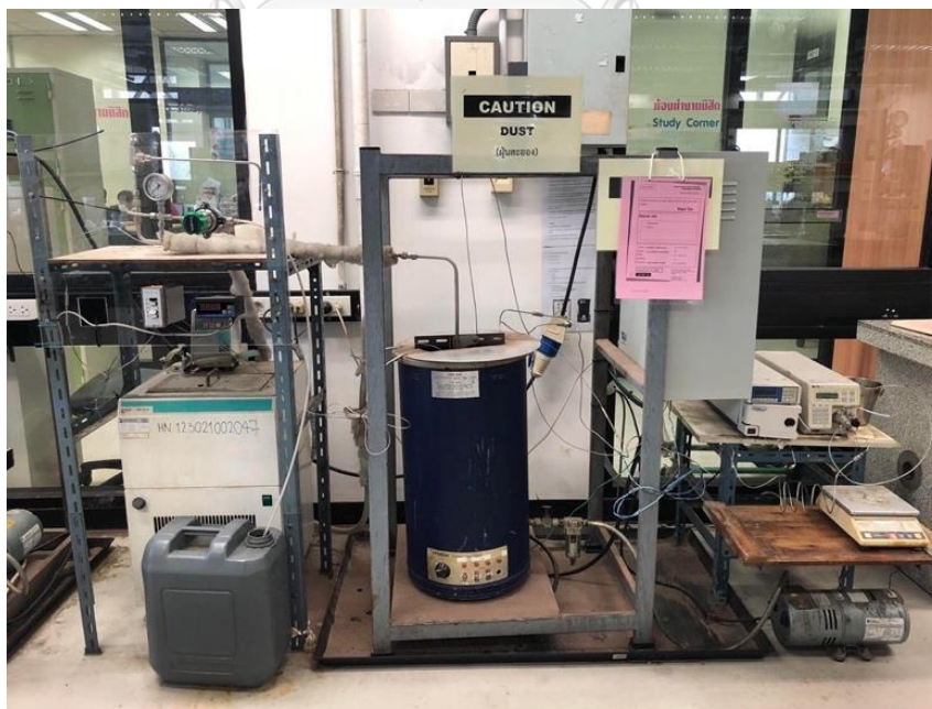
รูปที่ 3.3 เครื่องปฏิกรณ์แบบต่อเนื่อง (Continuous reactor)
