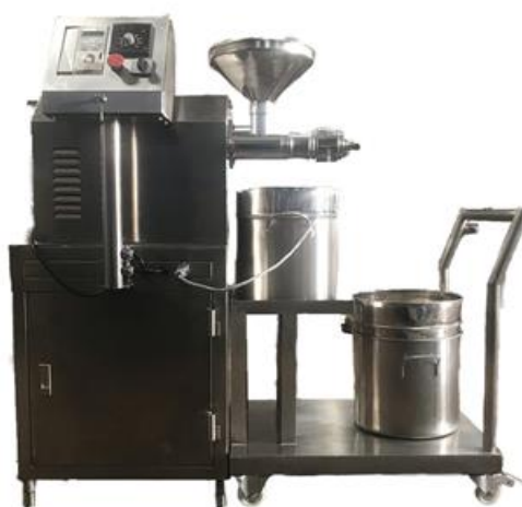
รูปที่ 2.2 เครื่องมือสกัดเชิงกลด้วยวิธีการบีบอัดด้วยเครื่องบีบอัดแบบ Screw press [13]
