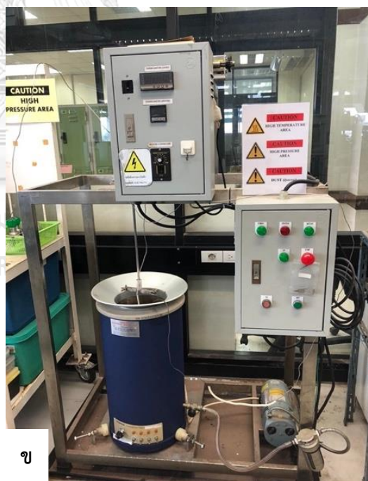
รูปที่ 3.2 ก) เครื่องปฏิกรณ์แบบแบตช์ (Batch reactor) และ ข) อ่างทรายฟลูอิดิซ (Fluidized sand bath) และแผงควบคุมอุปกรณ์
