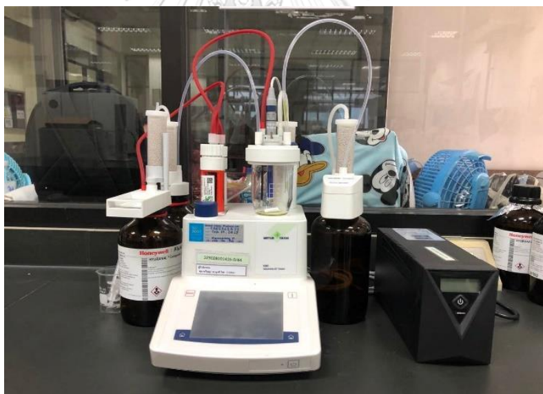
รูปที่ 3.1 เครื่องวิเคราะห์หาปริมาณน้ำโดยวิธีการไตเตรตด้วยเทคนิคคาร์ล ฟิสเซอร์ (Karl Fischer titration)
