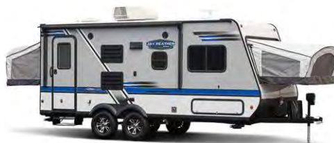
รูปที่2-9 รถบ้านเคลื่อนที่ ที่มีลักษณะเป็นรถพ่วงแบบลูกผสม 31
