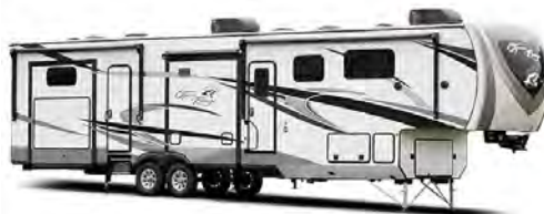
รูปที่2-10 รถบ้านเคลื่อนที่ ที่มีลักษณะเป็นรถพ่วงแบบ5ล้อ 32
