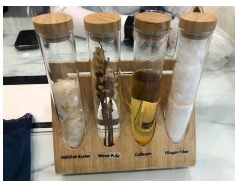
ภาพที่ 30 วัตถุดิบและกระบวนการผลิตเส้นใยฟิลาเจน ที่มา : กรรท พงศาโรจนวิทย์ ผู้วิจัย (2565)
