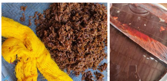
ภาพที่ 82 ขั้นตอนการย้อมเส้นใยพิวลาเจนผสมฝ้าย 50:50 ค่าแสดงกับกรรณิการ์ (ซ้าย), ค่าแสดงกับประดู่ (ขวา)
