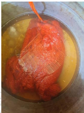
ภาพที่ 37 เส้นใยฟิลาเจนย้อมสารช่วยติดสี
