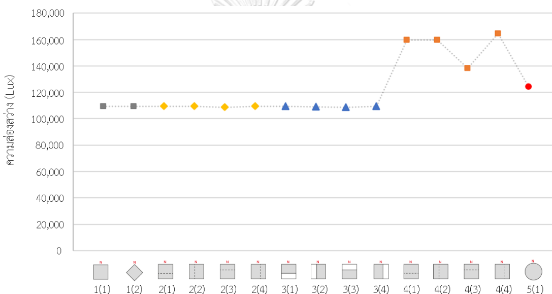
อาคารกรณีศึกษา แผนภูมิที่ 18 ค่าความส่องสว่างสูงสุดของแสงที่สะท้อนจากเปลือกอาคารกรณีศึกษาแต่ละรูปทรงลงบนพื้นราบ
