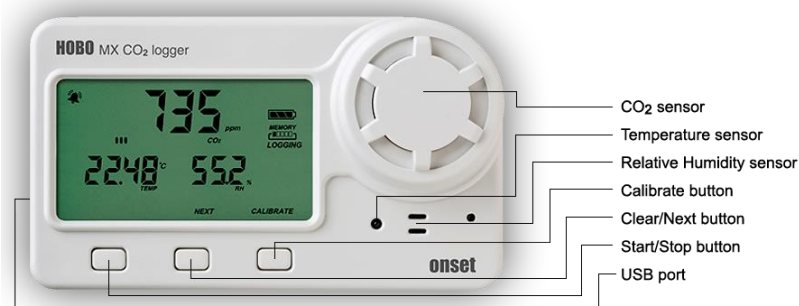
รูปที่ 35 เครื่อง HOBO MX CO 2 logger CO 2 sensor อุปกรณ์สำหรับการวัดก๊าซคาร์บอนไดออกไซด์
