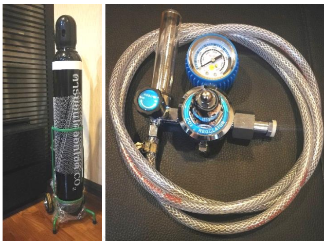
รูปที่ 34 ถังก๊าซ CO 2 และมาตรวัด CO 2
