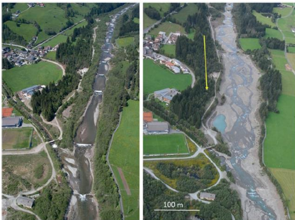
ภาพที่ 32 การเปลี่ยนแปลงของแม่น้ำจากการฟื้นฟู the Mareiterbach/Rio Ridanna, Italy ภาพก่อนการฟื้นฟู ค.ศ. 2005 (ซ้าย) และภาพหลังการฟื้นฟู ค.ศ. 2010 (ขวา) ที่มา Wohl (2018, p. 128)
