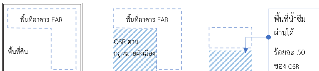
ภาพที่ 12 แผนภาพแสดงหลักเกณฑ์พื้นที่สีเขียวน้ำซึมผ่านสำหรับการปลูกต้นไม้
