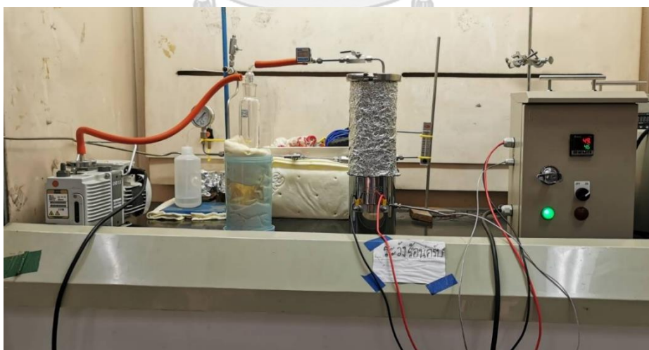
รูปที่ 3.3 รูปแบบกระบวนการปรับสภาพของน้ำมันหม้อแปลง
