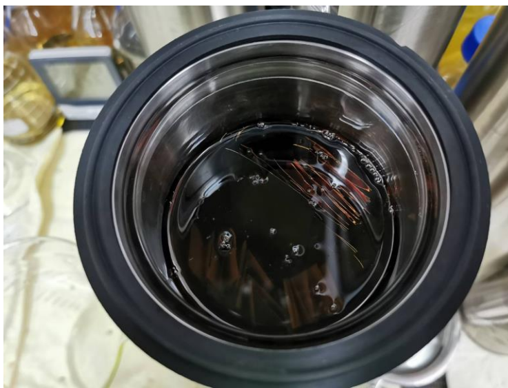
รูปที่ 3.4 การจุ่มแช่ของกระดาศนวนเซลลูโลส, แกลบเหล็กซิลิโคน และแกลบทองแดงลงในน้ำมันหม้อแปลงแต่ละชนิด
