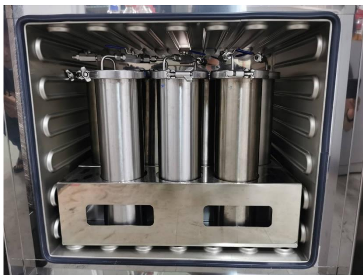
รูปที่ 3.5 การบรรจุท่อสแตนเลสแบบปิดภายในตู้อบลมร้อน
